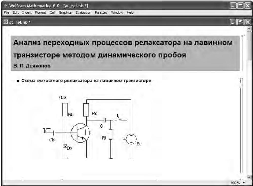
Рис. 10.34. Начальная часть ноутбука с расчетом параметров импульсов релаксатора на лавинном транзисторе
