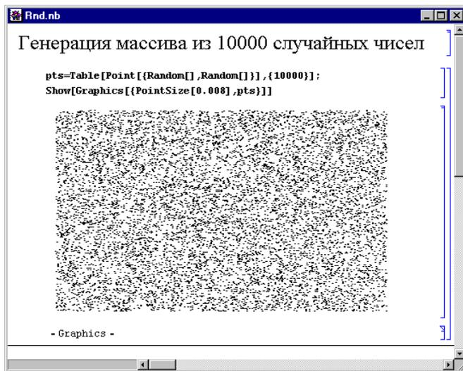
Рис. 3.1. Графическая иллюстрация распределения точек со случайными координатами (x,y)
