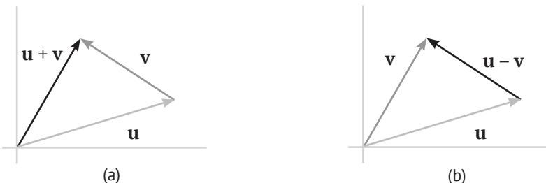
Рис. 3.3. Геометрическая интерпретация сложения и вычитания векторов
