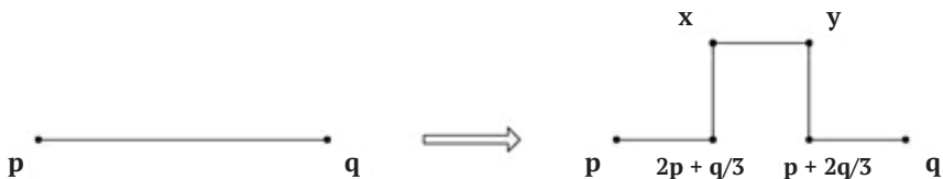
Рис. 10.26. Вариант разбиения линейного отрезка кривой Коха на пять меньших отрезков
