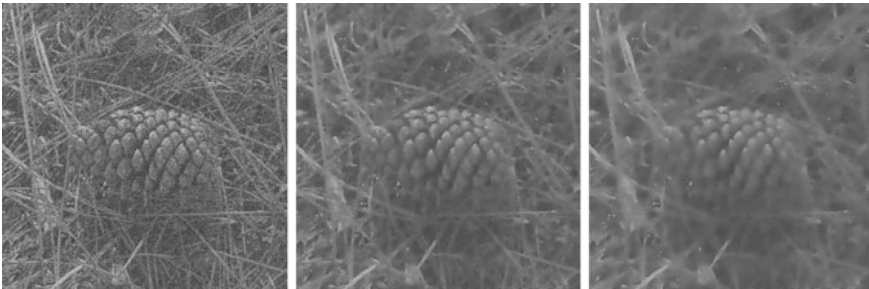
Рис. 6.8. Пример сглаживания изображения с помощью марковского случайного поля. Слева: исходное изображение. В центре: изображение, обработанное с параметром \lambda = 1 . Справа: изображение, обработанное с параметром \lambda = 0.5 . Можно видеть, что при меньшем значении \lambda в результате получается более сглаженное изображение
