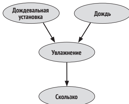
Рис. 13.2. Простой пример причинно-следственной байесовской сети, которая представляет следующие связи: Дождевальная установка (Sprinkler) – причина Увлажнения (Wet), Дождь (Rain) – причина Увлажнения (Wet), а Увлажнение (Wet) – причина скользкого состояния травы (Slippery) (пример взят из книги Дж. Перла (J. Pearl) [3])
