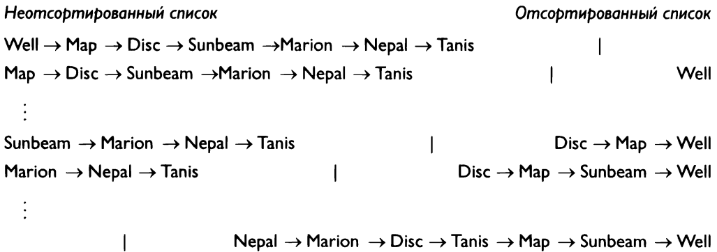
Рис. 6.2. При сортировке вставками следующий элемент вставляется из неотсортированного списка (слева от вертикальной черты) в отсортированный список (справа)
