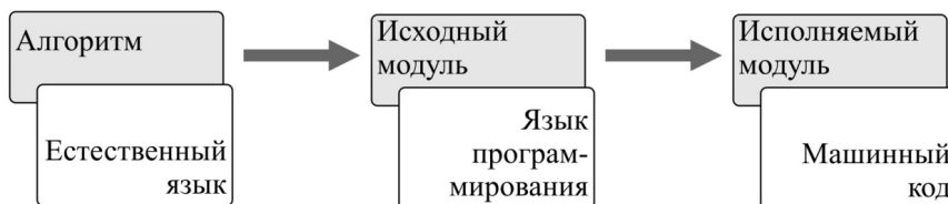
Рис. 27. Процесс создания программы в машинном коде
