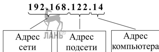
Рис. 35. Структура сетевого IP-адреса
