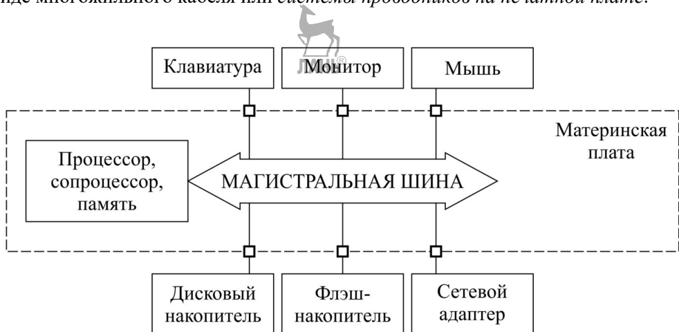
Рис. 20. Упрощенная блок-схема персонального компьютера
