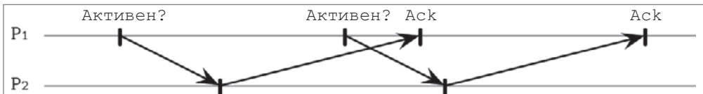
Рис. 9.2. Обнаружение отказов с помощью эхо-запросов (ping): ответы задерживаются, приходя после отправки следующего сообщения
