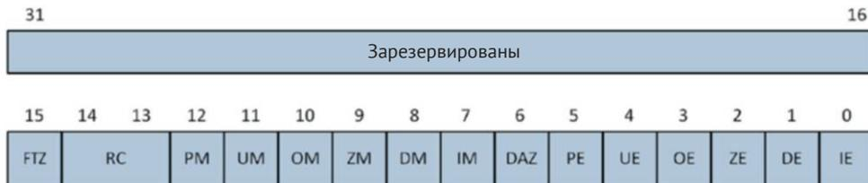
Рис. 4.11. Регистр управления и состояния MXCSR
