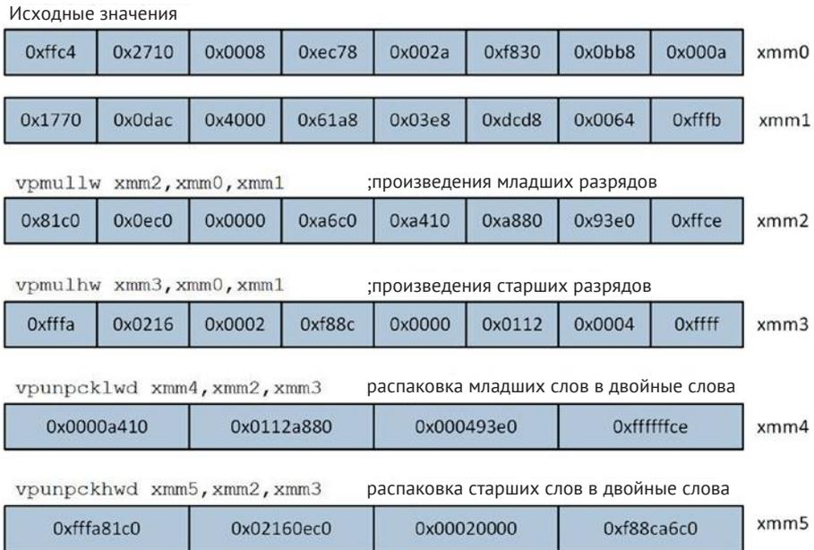
**Рис. 7.1.** Последовательность команд функции `AvxPackedMulI16_` для перемножения упакованных 16-разрядных целых чисел со знаком
