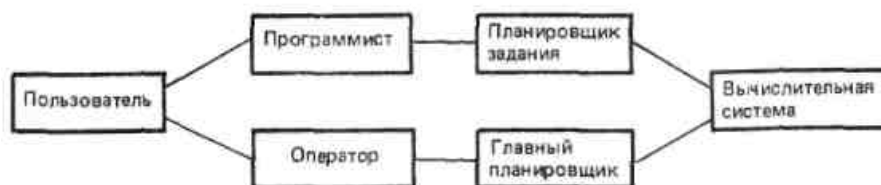
Рис. 3.1. Схема связи пользователя с вычислительной системой
