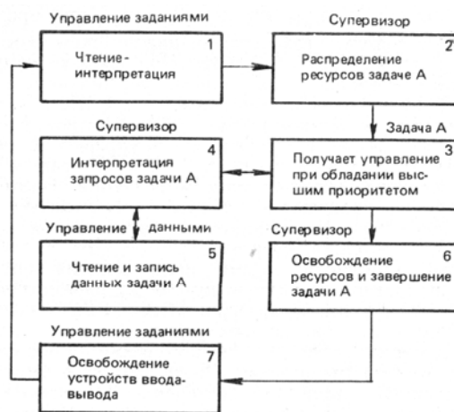
Рис. 3.9. Схема цикла работы управляющей программы
