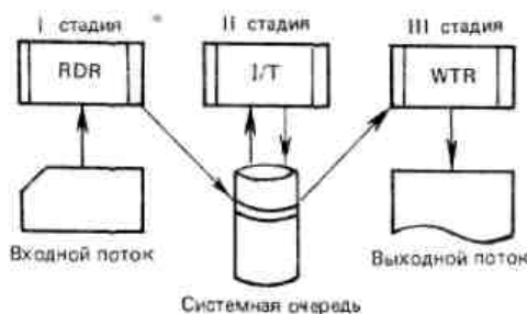
Рис. 3.4. Схема прохождения задания в ОС ЕС
