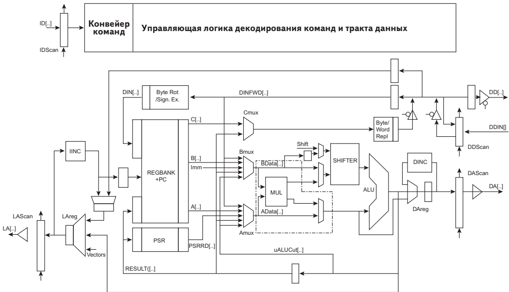
Рис. 2.70. Блок-схема процессора ARM9 (печатается с разрешения ARM. © 1999 ARM Ltd.)
