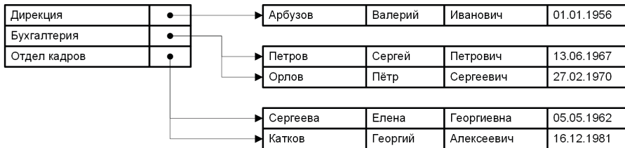
Рис. 1.4. Пример работы иерархической БД
