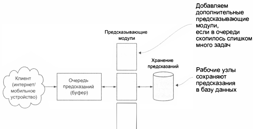
Илл. 9.7. Вариант инфраструктуры для масштабируемой службы предсказаний. Запросы посылаются от заказчика в очередь, которая делегирует их выполнение какому-то из рабочих узлов. Этот узел сохраняет предсказание в базе данных и после завершения работы возвращает клиенту. При переполнении очереди, когда запросов поступает больше, чем узлы могут обработать, добавляются новые узлы
