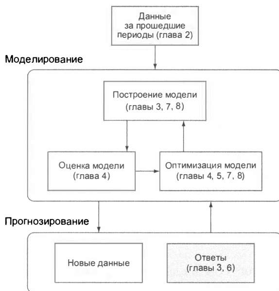
Илл. 1.7. Рабочий процесс реальных систем с машинным обучением. Данные за прошедшие периоды позволяют построить модель на базе ML-алгоритма. После этого нужно оценить производительность модели и оптимизировать ее точность и масштабируемость в соответствии с выдвинутыми требованиями. Готовая модель дает прогнозы для новых данных
