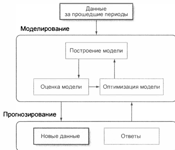
Илл. 2.1. Базовый процесс машинного обучения. Так как в этой главе пойдет речь о данных, мы выделили фрагменты, соответствующие данным за прошедшие периоды и новым данным
