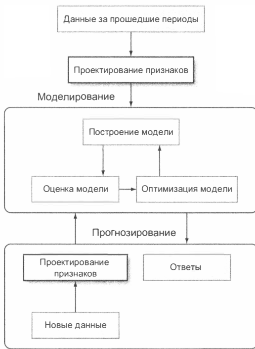
Илл. 5.1. Проектирование признаков как часть базового рабочего процесса ML. Перед построением модели мы добавляем в обучающую выборку новые признаки. На стадии прогнозирования нужно пропустить новые данные через тот же самый процесс проектирования признаков, чтобы убедиться в осмысленности ответов
