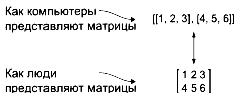
Рис. 2.1. Матрица в нижней половине диаграммы представляет собой визуализацию из ее компактной нотации кода в верхней половине диаграммы. Эта форма обозначения является общей парадигмой в большинстве научных вычислительных библиотек
