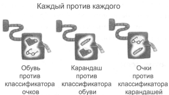
Рис. 4.17. В многоклассовой классификации «каждый против каждого» для каждой пары меток используется свой детектор
