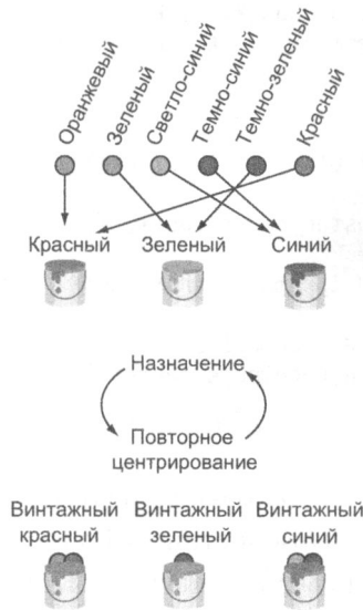
Рис. 5.6. Одна итерация алгоритма k -средних. Представим, что данные необходимо разбить на три сегмента (или категории ). Процесс можно запустить с начальным приближением деления на красный, зеленый и синий сегменты и приступить к шагу присваивания. Затем выполняется обновление цветов в сегментах с усреднением цветов, принадлежащих к каждому сегменту. Итерации продолжаются, пока сегменты заметным образом не меняют цвет, приходя к окончательному представлению цвета каждого кластера
