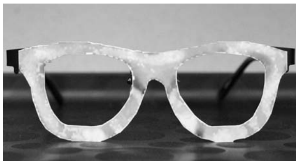
Рис. 1.7. Вредоносные очки, созданные с целью обмануть системы распознавания лиц (изображение из статьи Шарифа и др. от 2016 года)
