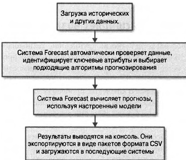
Рис. 17.1. Пример конвейера в виде службы для прогнозирования временных рядов. Такие службы предлагаются как небольшими стартапами, так и крупными компаниями, среди которых выделяется Amazon, развернувшая набор инструментов, предназначенных для автоматического прогнозирования временных рядов и масштабирования на основе машинного обучения и статистических моделей
