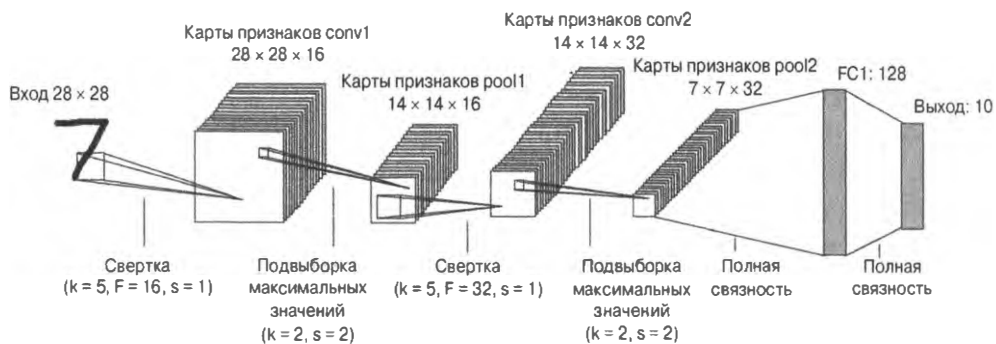
Рис. 10.8. Сверточная сеть. Многие двумерные окна с заданным размером ядра скользят по исходному изображению, создавая множество карт признаков, основанных на получаемых при обучении весах. Часто они объединяются и обрабатываются с помощью функции активации. Процесс повторяется несколько раз на нескольких уровнях, чтобы свести множество признаков к меньшему диапазону значений, что в конечном итоге можно использовать в разного рода оценках, например в задачах классификации
