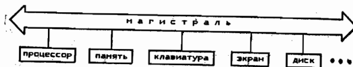
Рис. 19.1. Общая схема ЭВМ архитектуры PDP-11
