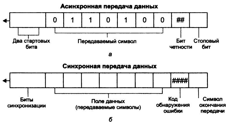
Рис. 1.8. Асинхронная (а) и синхронная (б) передача данных
