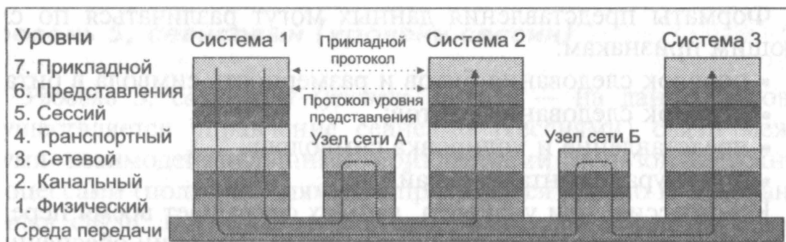
Рис. 1.12. Взаимодействие уровней в эталонной модели OSI (BOC)
