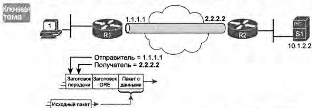
Рис. 7.9. Инкапсуляция первоначального пакета IP в пакет формата GRE
