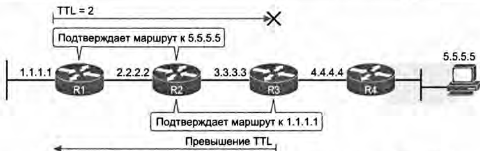
Рис. 4.20. Сообщения, позволяющие команде traceroute вывести адрес 3.3.3.3
