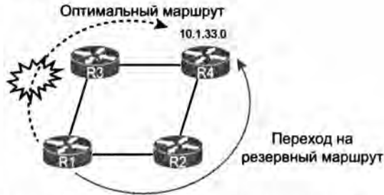
Рис. 10.8. Схема события конвергенции описывается в следующем примере
