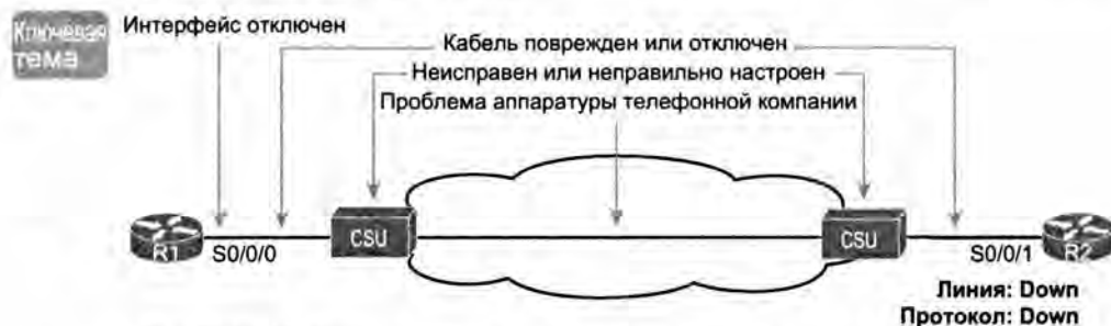
Рис. 12.16. Проблемы, приводящие к состоянию down/down на маршрутизаторе R2
