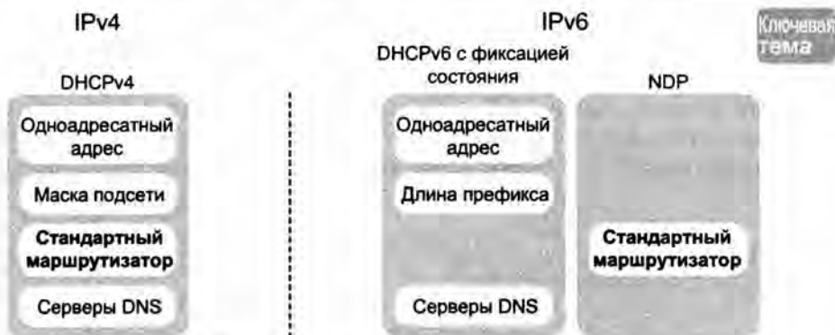
Рис. 16.5. Источники параметров IPv6 при использовании протокола DHCP с фиксацией состояния
