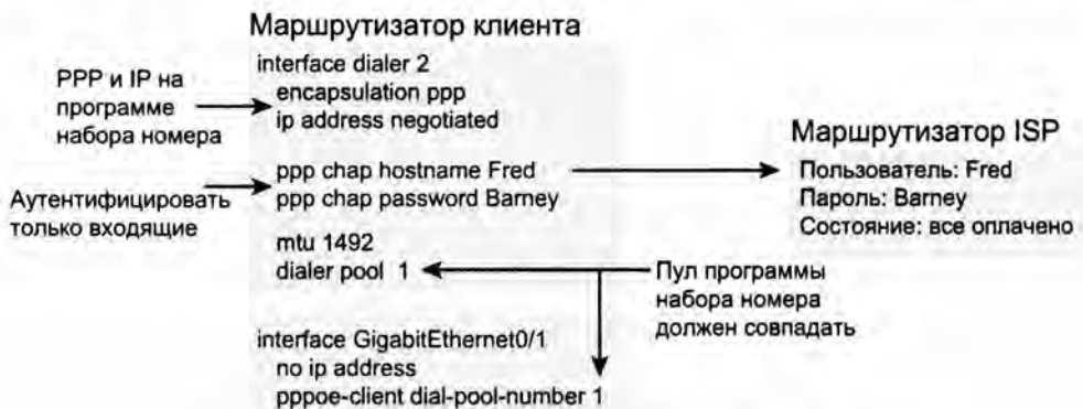
Рис. 15.14. Конфигурация клиента для протокола PPPoE
