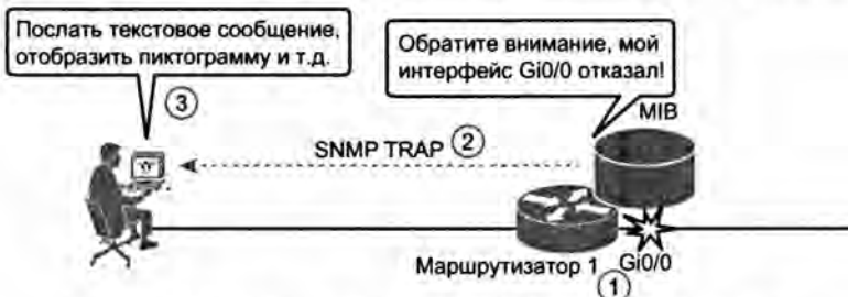
Рис. 19.3. Использование протокола SNMP для контроля сети
