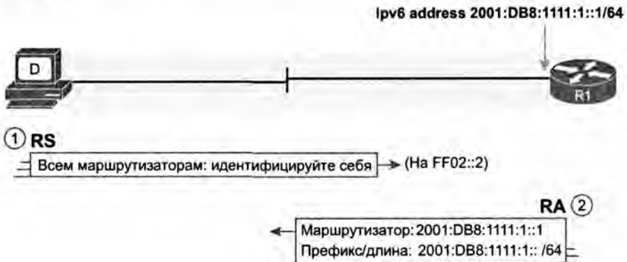
Рис. 16.17. Процесс NDP RS и RA
