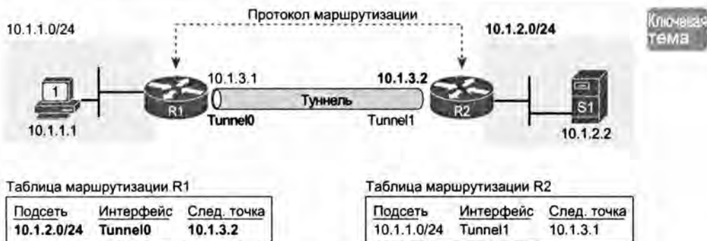
Рис. 7.7. Туннельные маршрутизаторы получают маршруты по туннелю IP
