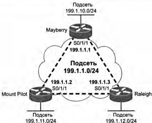
Рис. 13.11. IP-адреса в полносвязной топологии
