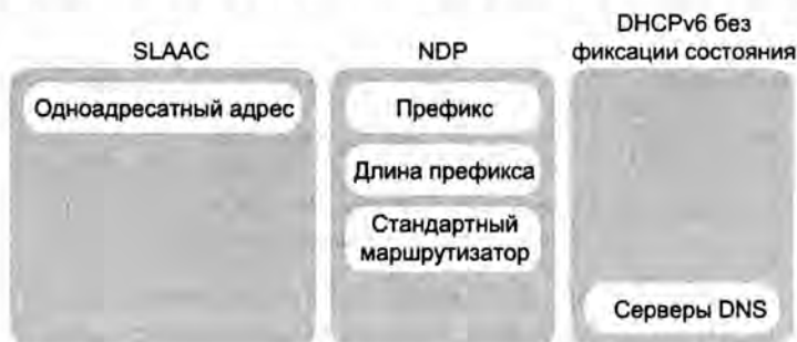
Рис. 16.7. Источники параметров IPv6 при использовании SLAAC
