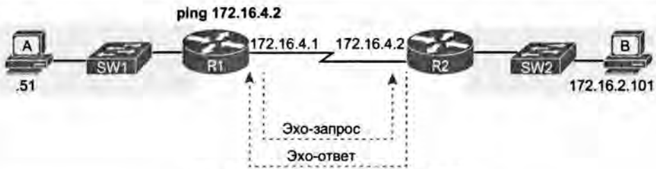
Рис. 4.14. Проверка канала связи WAN
