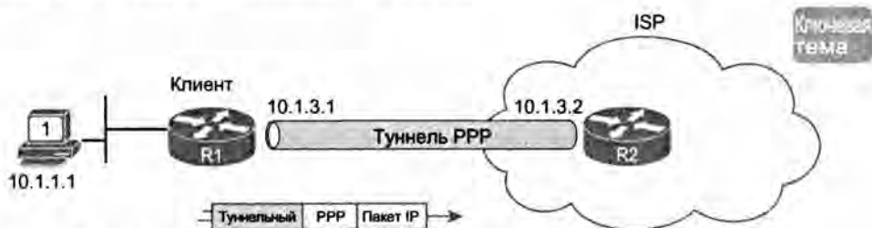
Рис. 15.13. Концепция создания туннеля в канале связи PPP поверх Ethernet
