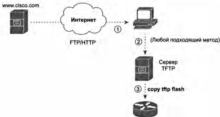
Рис. 20.2. Копирование образа IOS в ходе процесса обновления программного обеспечения Cisco IOS
