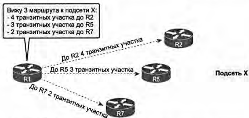
Рис. 9.4. Графическое представление дистанционно-векторной концепции
