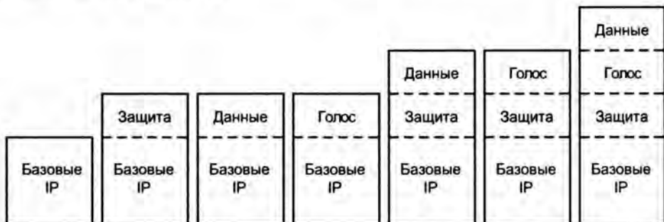
Рис. 21.2. Старый пакет образов IOS: разные образы с разными наборами средств
