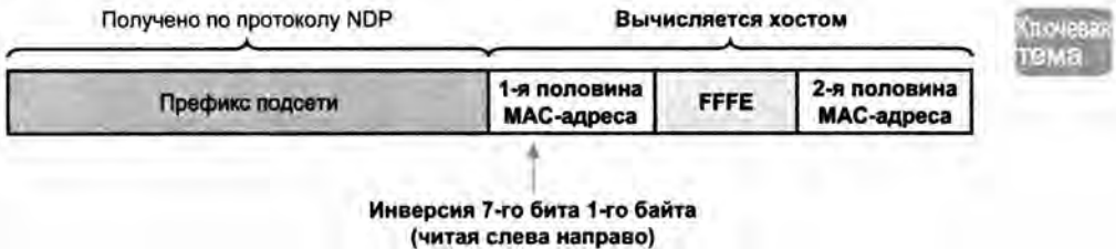
Рис. 16.8. Формат IPv6-адреса с идентификатором интерфейса и частью EUI-64
