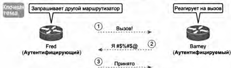
Рис. 12.14. Процесс аутентификации CHAP
