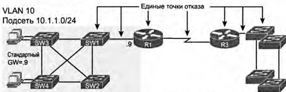
Рис. 6.1. Маршрутизатор R1 и единственный канал связи WAN как единые точки отказа
