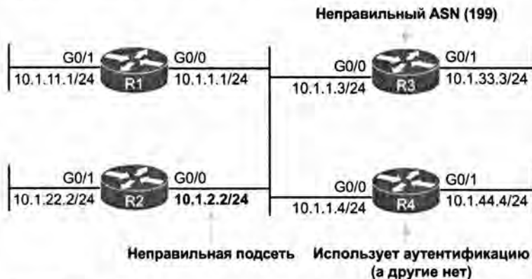
Рис. 11.5. Проблемы, препятствующие соседским отношениям EIGRP в сети LAN
