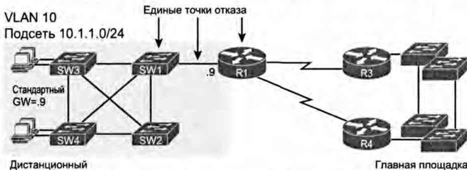
Рис. 6.2. Более высокая доступность, но маршрутизатор R1 — все еще единая точка отказа
