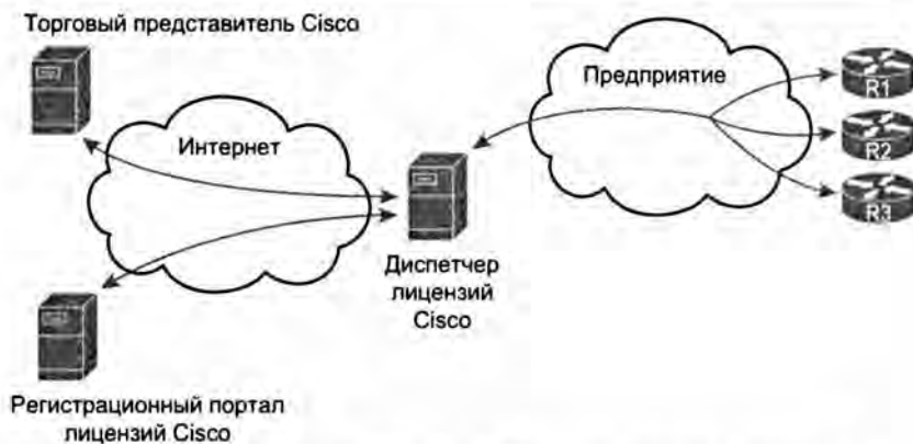
Рис. 21.5. Роль диспетчера лицензий Cisco в программной активации
