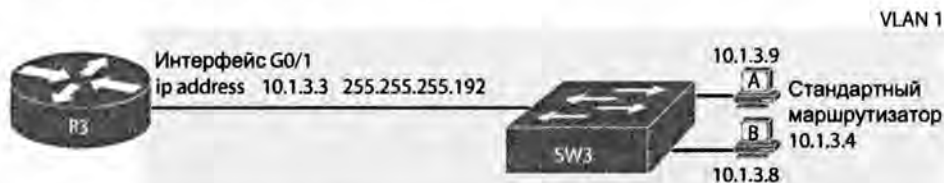
Рис. 5.6. Неправильный параметр стандартного маршрутизатора на хостах А и В
