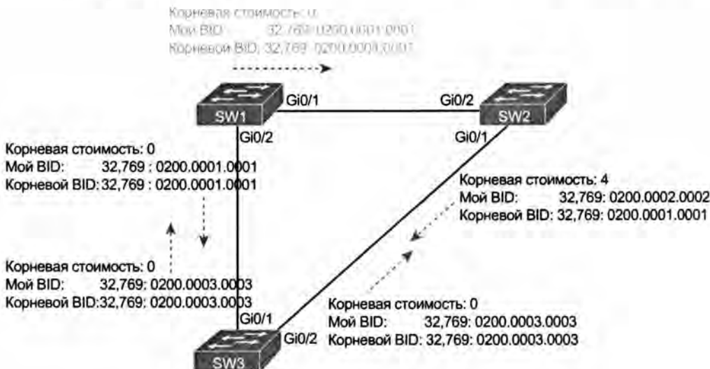
Рис. 1.5. Начало процесса выборов корневого коммутатора
