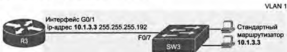
Рис. 5.7. Конфигурация IP-адреса маршрутизатора без магистрального соединения
