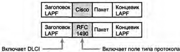
Рис. 13.6. Инкапсуляции Cisco и RFC 1490/2427
