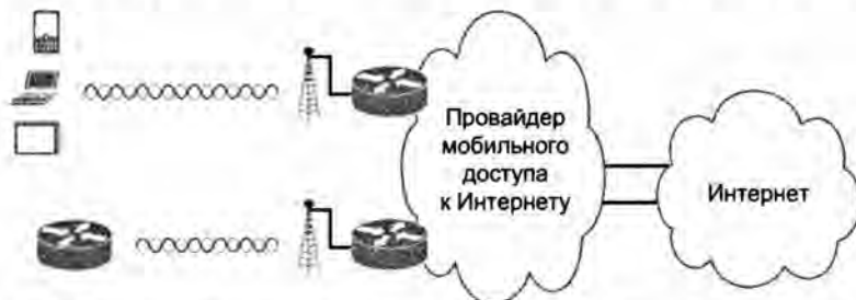
Рис. 15.11. Беспроводной доступ к Интернету с использованием технологий 3G/4G
