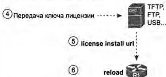
Рис. 21.7. Копирование и установка лицензии на маршрутизаторе
