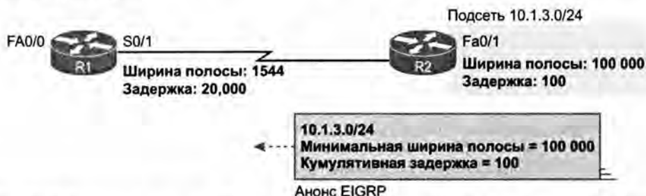
Рис. 9.10. Как маршрутизатор R1 вычисляет свою метрику EIGRP для маршрута 10.1.3.0/24
