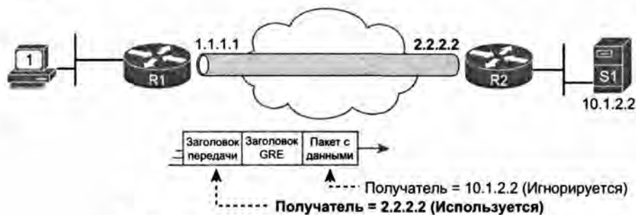
Рис. 7.10. Маршрутизаторы Интернета перенаправляют пакет IP GRE на основании открытых IP-адресов
