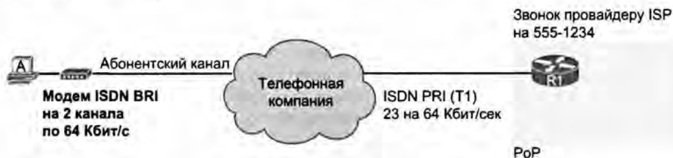
Рис. 15.8. Типичное соединение ISDN
