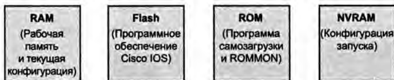
Рис. 20.1. Типы памяти маршрутизатора и их назначение
