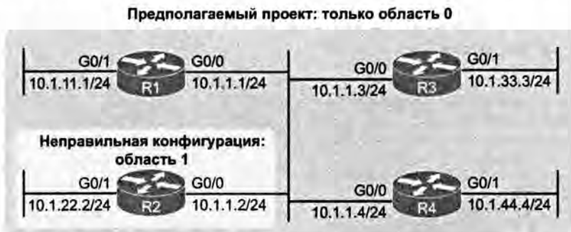
Рис. 11.4. Проект предполагал использовать только область 0, а маршрутизатор R2 нарушил это требование
