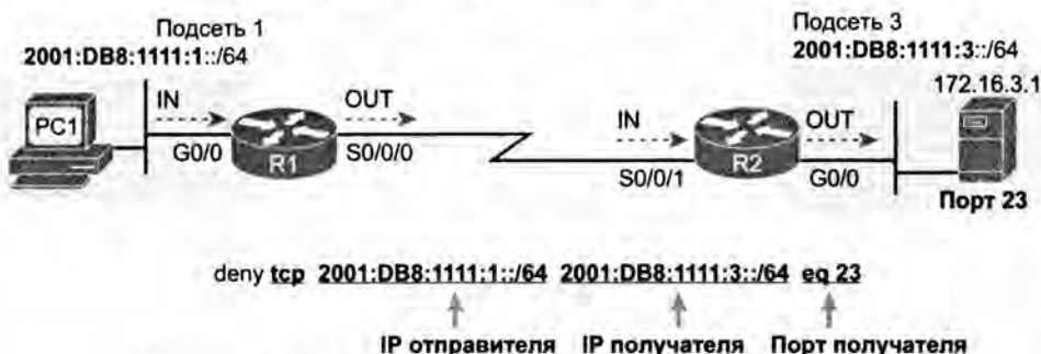
Рис. 16.19. Фильтрация пакетов IPv6 на основании порта получателя
