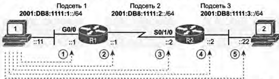
Рис. 16.11. Последовательность проверки при изоляции проблемы маршрутизации IPv6
