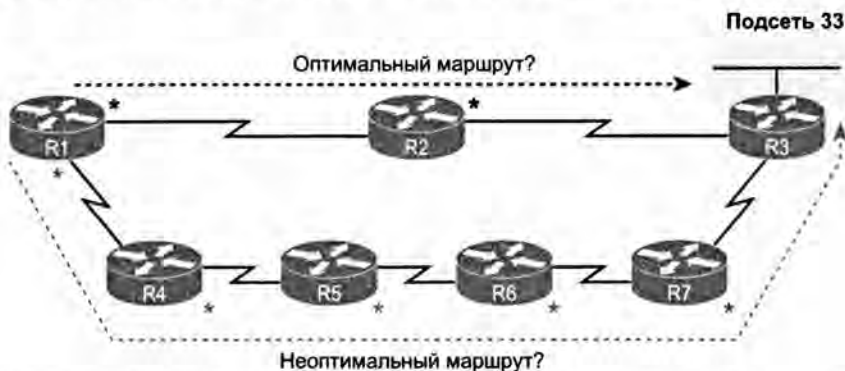
Рис. 17.9. Длинный и короткий параллельные маршруты от маршрутизатора R1 к подсети 33
