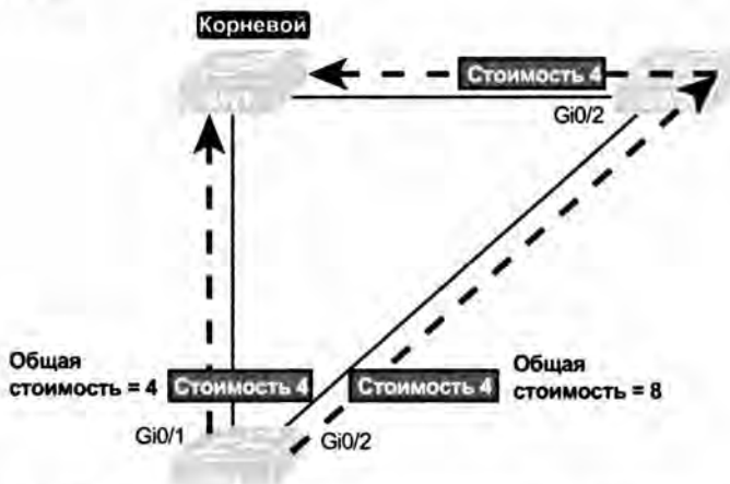
Рис. 2.5. Анализ текущей корневой стоимости коммутатора SW3 со стандартным значением 4
