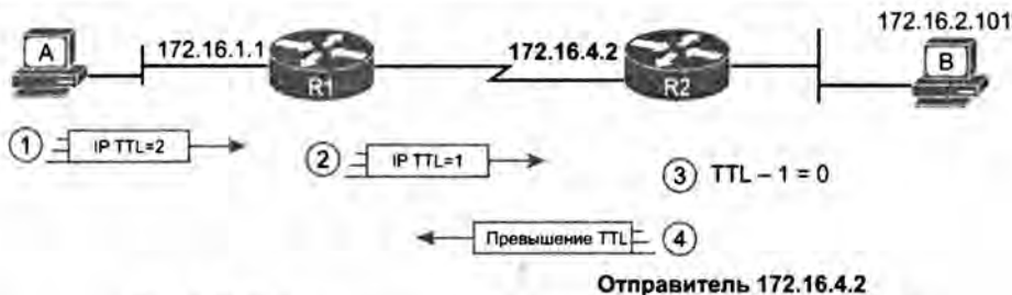
Рис. 4.18. TTL посланного командой traceroute сообщения равно 2
