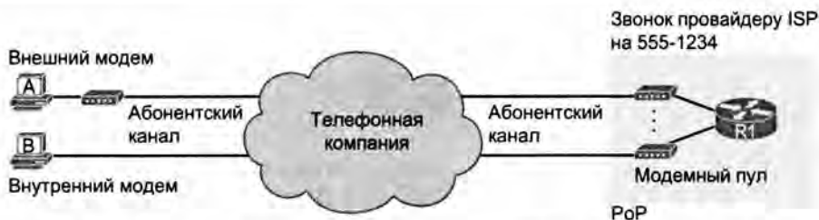
Рис. 15.7. Доступ к Интернету с использованием внешних и внутренних модемов
