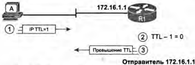
Рис. 4.17. Как команда traceroute идентифицирует первый маршрутизатор на маршруте
