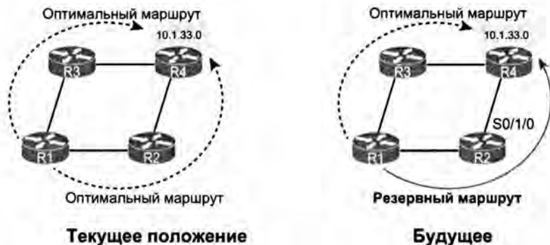
Рис. 10.6. Сравнение двух оптимальных маршрутов для получения одного оптимального и одного резервного маршрутов
