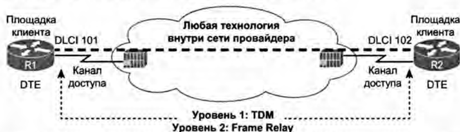
Рис. 15.2. Общие элементы, используемые для идентификации глобальных сетей Frame Relay
