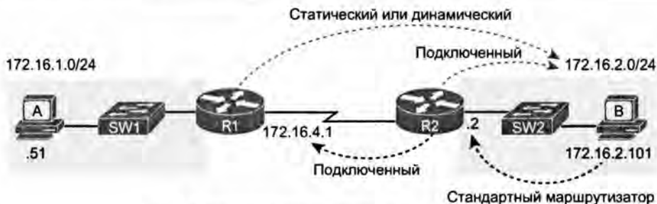
Рис. 4.8. Для успеха команды ping 172.16.2.101 на маршрутизаторе R1 необходимы маршруты уровня 3
