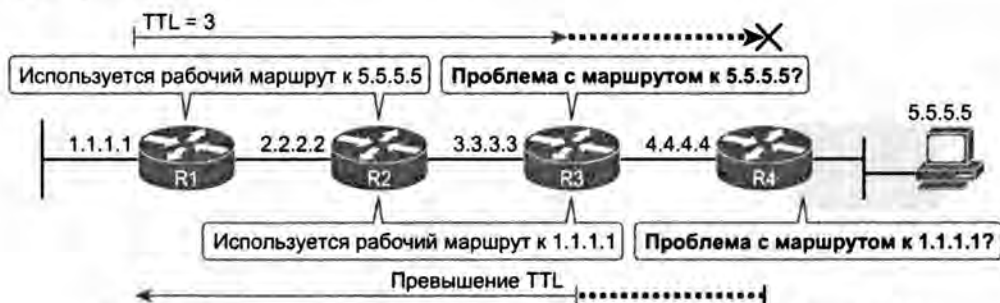
Рис. 4.21. Сообщения, позволяющие команде traceroute вывести адрес 4.4.4.4
