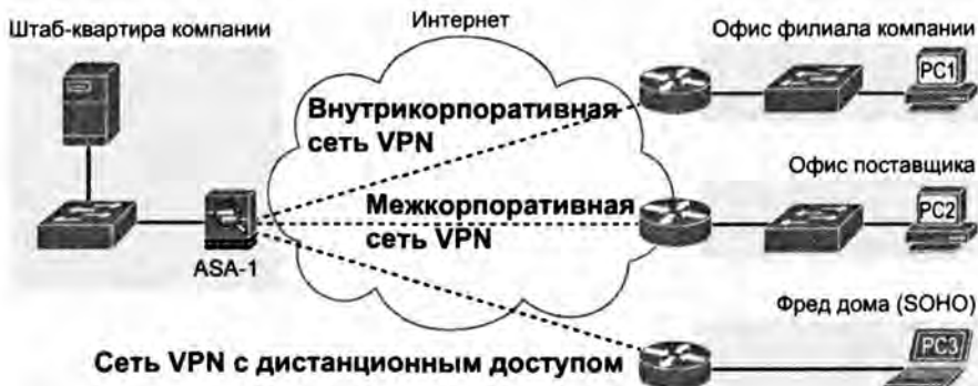
Рис. 7.2. Внутрикорпоративные сети VPN (Intranet VPN), межкорпоративные сети VPN (Extranet VPN) и сети VPN с дистанционным доступом (Access VPN)
