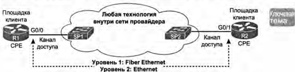
Рис. 15.3. Служба WAN Ethernet по сравнению со службой Frame Relay
