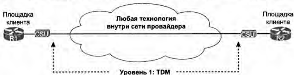
Рис. 15.1. Двухточечная выделенная линия
