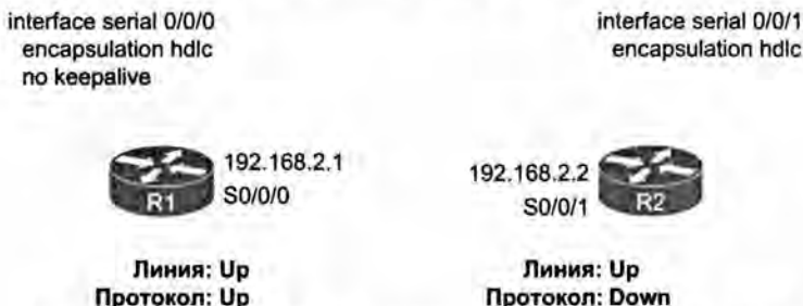
Рис. 12.17. Причины состояния down/down на маршрутизаторе R2
