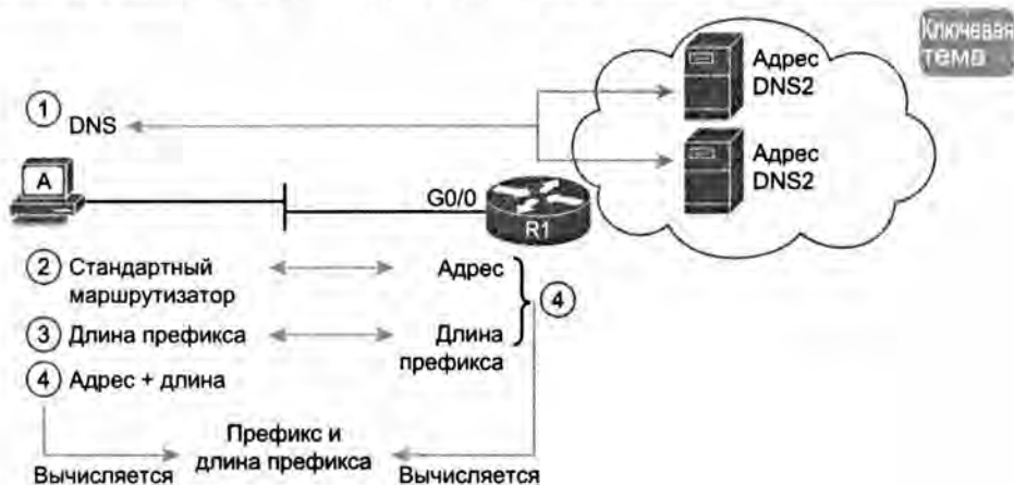
Рис. 16.13. Параметры IPv6 хоста по сравнению со значениями, которым они должны соответствовать
