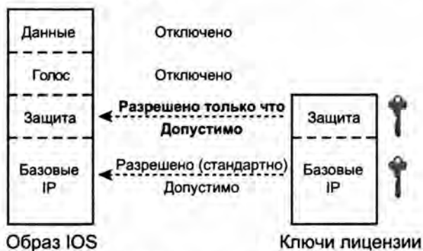
Рис. 21.4. Ключи лицензии на маршрутизаторе, разрешающие средства IOS
