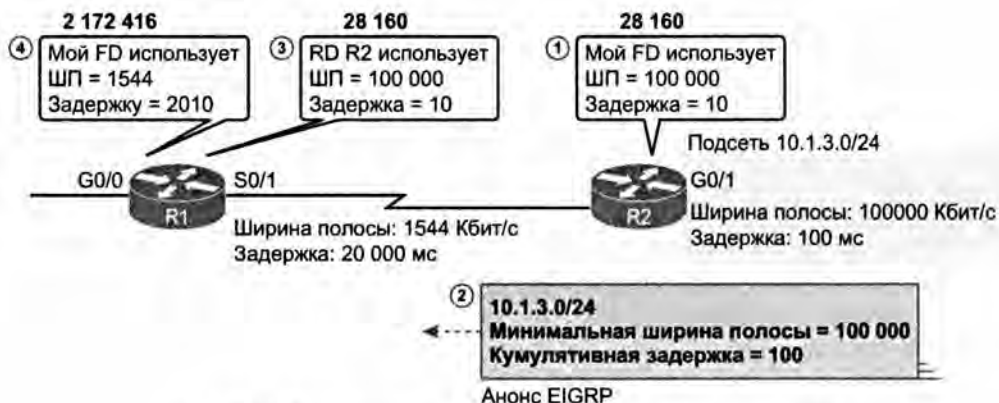
Рис. 9.12. Как маршрутизатор R1 вычисляет анонсируемое (RD) и оптимальное (FD) расстояния для подсети 10.1.3.0/24
