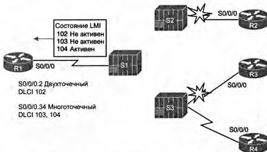
Рис. 14.9. Результат отключения каналов доступа маршрутизаторов R2 и R3
