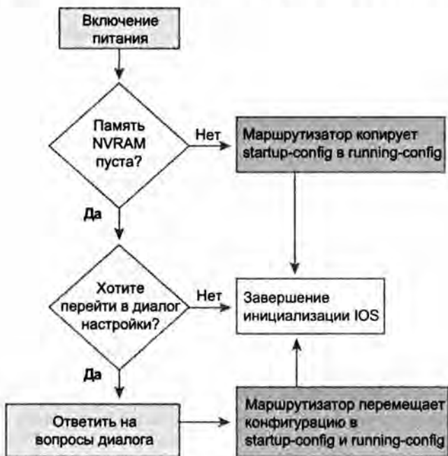
Рис. 20.6. Логика и описание диалога начальной загрузки после перезагрузки
