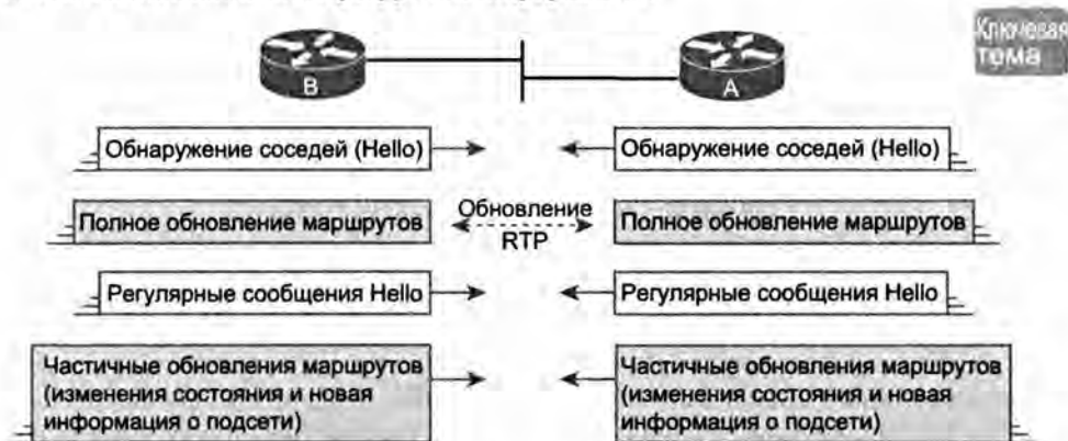
Рис. 9.9. Полные и частичные обновления EIGRP
