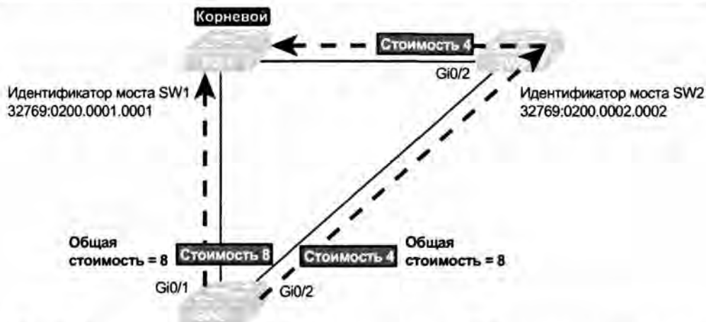
Рис. 2.8. Вычисление корневых стоимостей на коммутаторе SW3 заканчивается равенством
