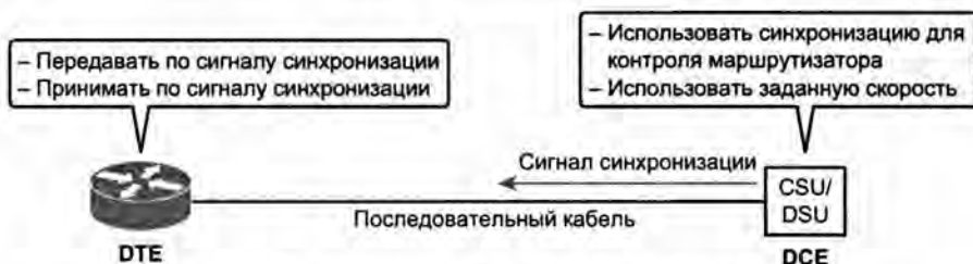
Рис. 12.7. Роли устройств DCE и DTE для модуля CSU/DSU, а также последовательного интерфейса маршрутизатора
