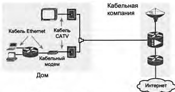
Рис. 15.10. Кабели и устройства домашнего кабельного Интернета
