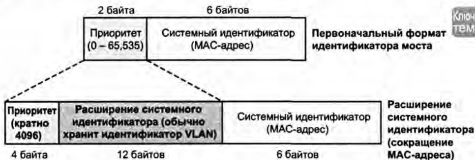
Рис. 2.3. Расширение системного идентификатора STP
