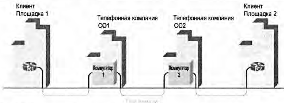
Рис. 12.3. Возможная кабельная проводка телефонной компании для короткой выделенной линии
