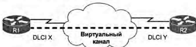
Рис. 13.2. Виртуальные каналы сети Frame Relay
