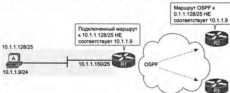
Рис. 5.4. У маршрутизаторов нет маршрута, соответствующего адресу 10.1.1.9 хоста А
