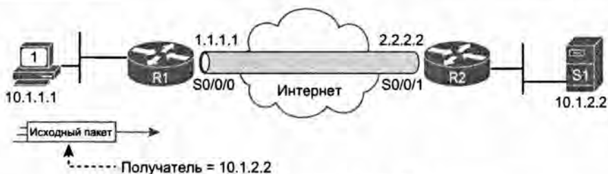
Рис. 7.8. Передача по туннелю через Интернет
