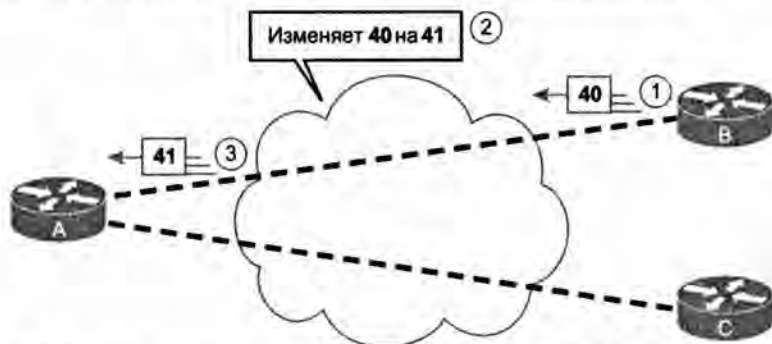
Рис. 13.9. Перенаправление Frame Relay от маршрутизатора В к маршрутизатору А
