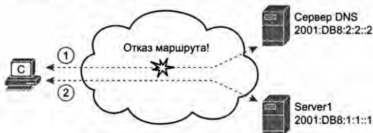
Рис. 16.15. Преобразование имен перед передачей пакетов на сервер
