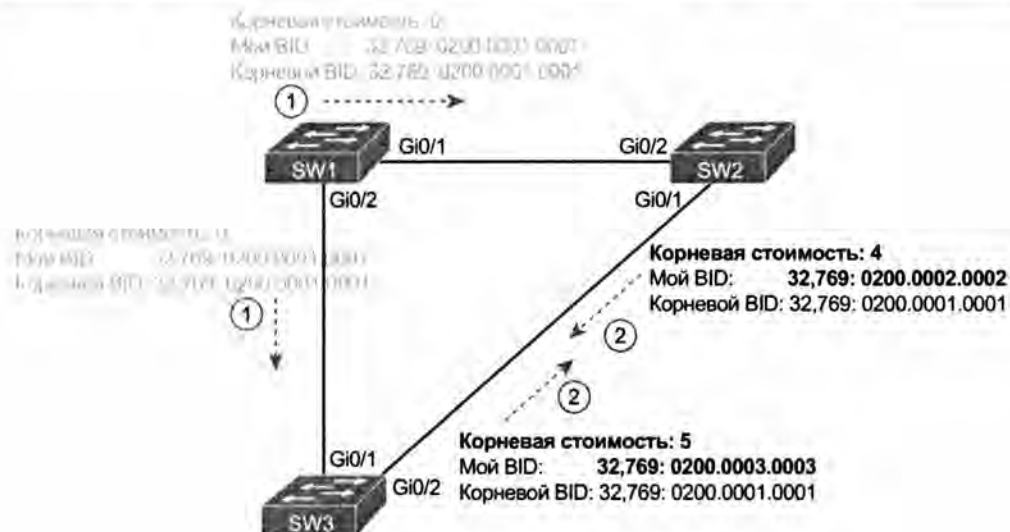
Рис. 1.6. Коммутатор SW1 побеждает на выборах
