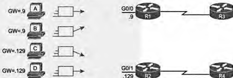
Рис. 6.4. Балансировка трафика за счет назначения разных стандартных маршрутизаторов разным клиентам
