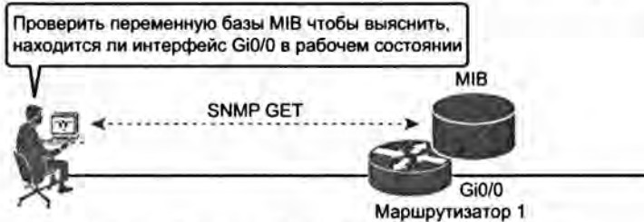
Рис. 19.2. Протокол SNMP в процессе контроля сети
