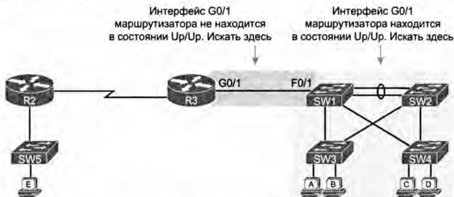
Рис. 16.14. Где искать источник неисправности на основании состояния интерфейса LAN маршрутизатора
