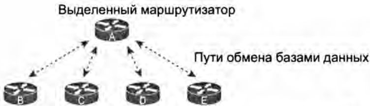
Рис. 8.5. Обмен базами данных с выделенным маршрутизатором в сети Ethernet
