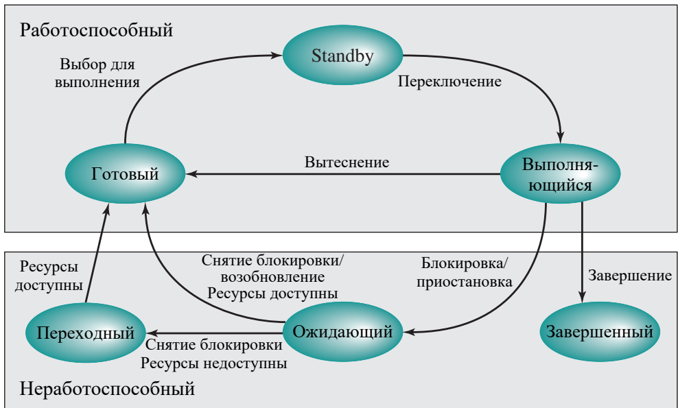
Рис. 4.11. Состояния потоков в операционной системе Windows
