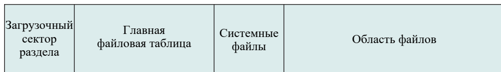
Рис. 12.19. Схема тома NTFS
