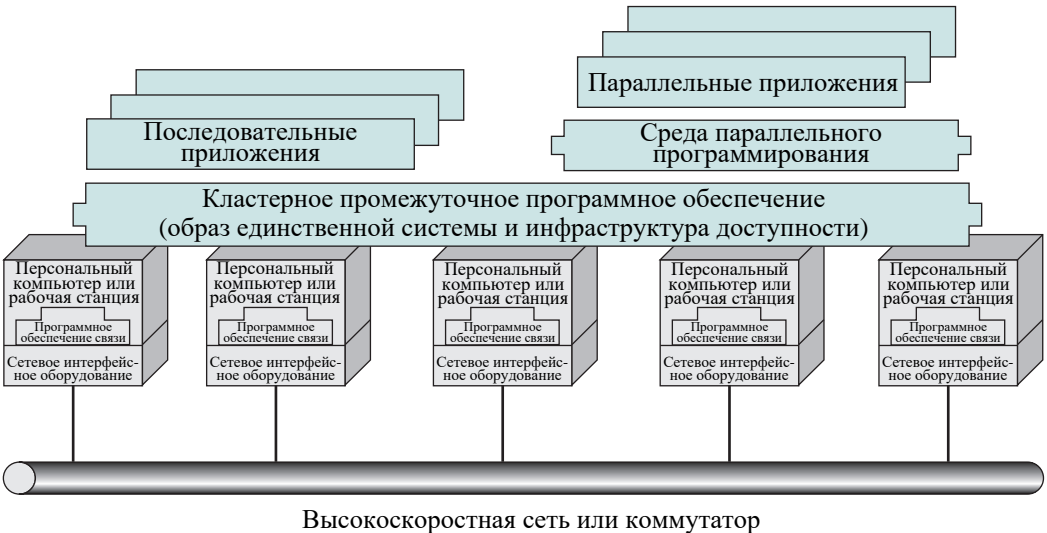
Рис. 18.14. Архитектура кластерной вычислительной системы
