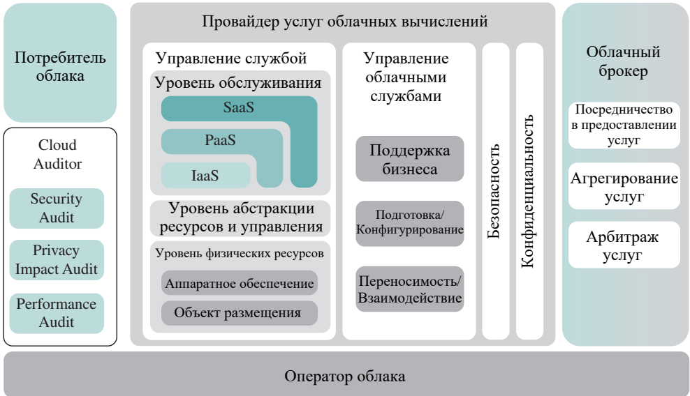
Рис. 16.3. Эталонная архитектура облачных вычислений, разработанная в NIST
