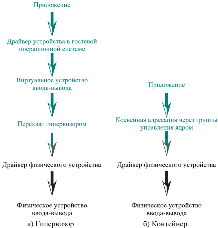
Рис. 14.5. Прохождение потока данных в операции ввода-вывода через гипервизор и контейнер
