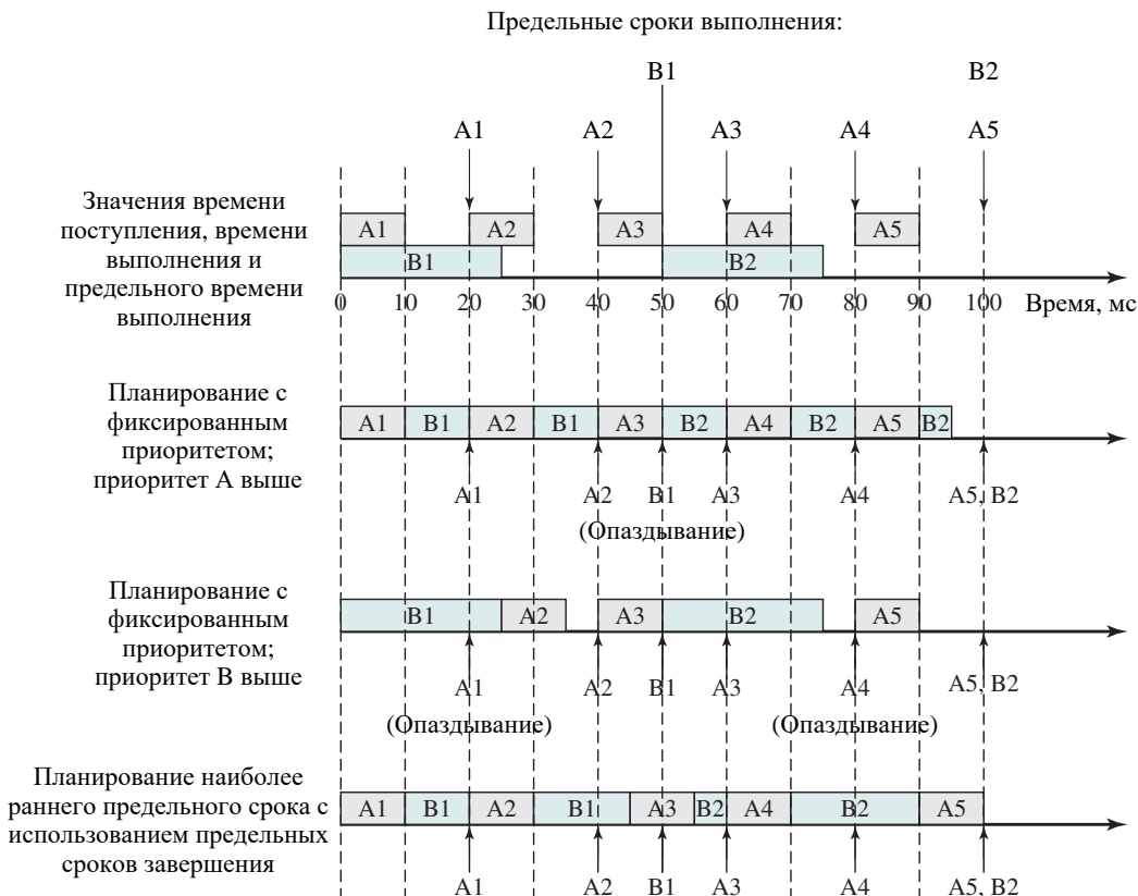
Рис. 10.5. Планирование периодических заданий реального времени с предельными сроками завершения (на основании табл. 10.3)
