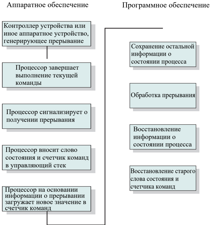
Рис. 1.10. Обработка простого прерывания
