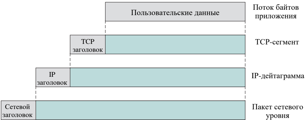
Рис. 17.5. Протокольные блоки данных (PDU) в архитектуре TCP/IP
