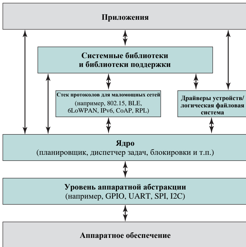
Рис. 16.13. Типичная структура операционной системы для IoT
