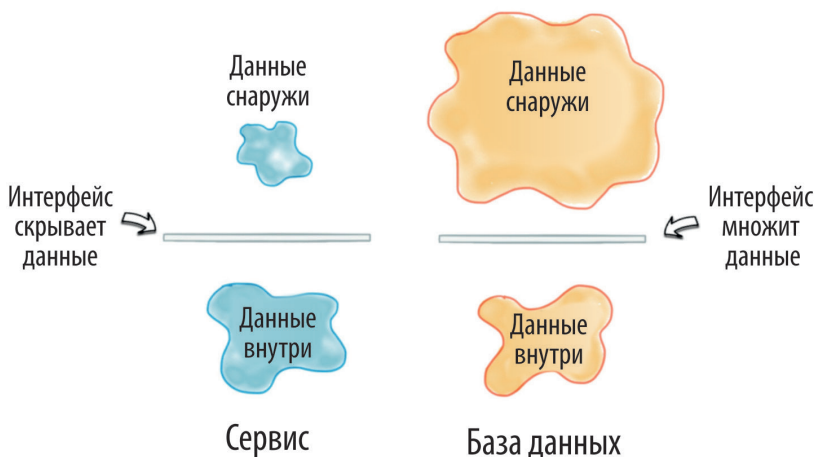
Рис. 8.2. Сервисы инкапсулируют свои данные для снижения связанности и помощи в повторном использовании; базы данных множат свои данные для увеличения полезности для своих пользователей
