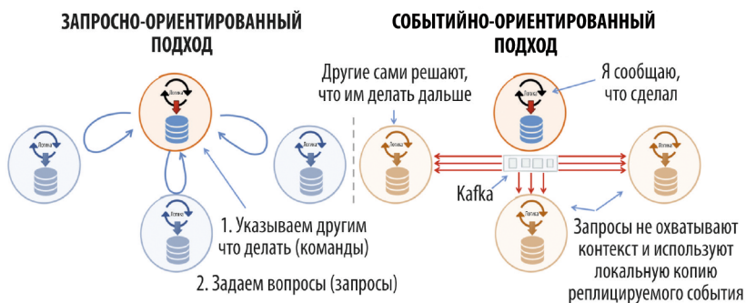
Рис. 5.2. Сравнение подхода «запрос-ответ» и событийно-ориентированного подхода для демонстрации меньшей связанности последнего
