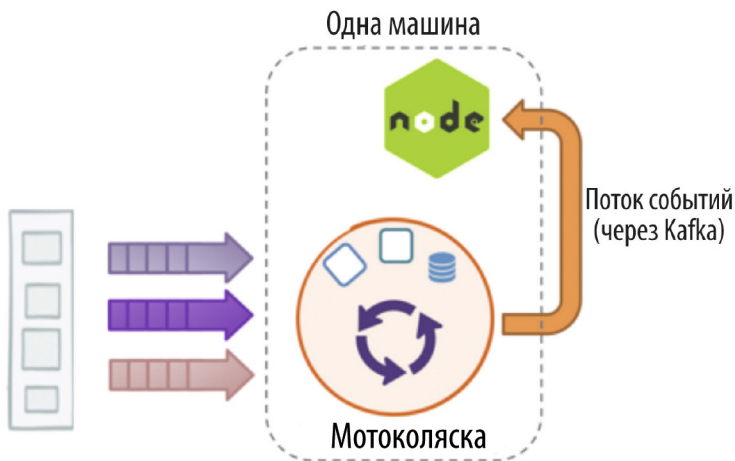
Рис. 14.2. Операция потоковой передачи выполняется через шаблон «мотоколяска»; обработка результирующего потока выполняется в клиенте Node.js
