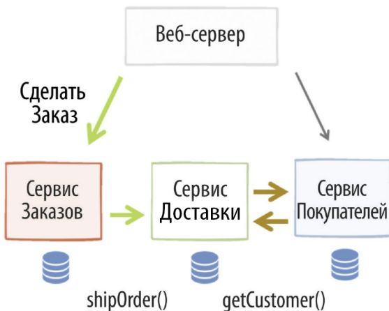
Рис. 5.3. Система управления заказами, основанная на запросах
