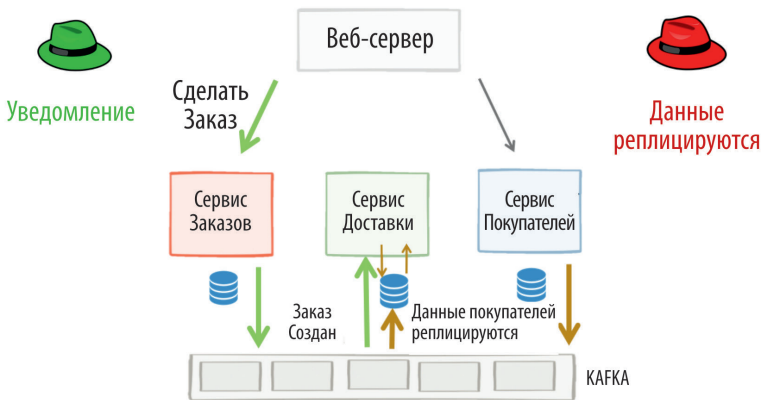
Рис. 5.6. Расширение системы из рис. 5.4 до полностью событийно-ориентированной; здесь события используются для уведомлений (сервис заказа уведомляет сервис доставки), а также для репликации данных (данные передаются из сервиса клиента в сервис доставки, где могут быть запрошены локально)
