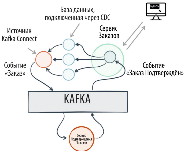
Рис. 7.9. Пример записи в поток событий через базу данных
