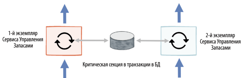
Рис. 15.4. Два экземпляра сервиса управляют параллельными операциями через общую базу данных
