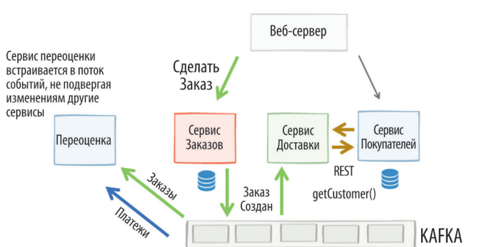
Рис. 5.5. Расширение системы из рис. 5.4 путём добавления сервиса переоценки демонстрирует модульность архитектуры
