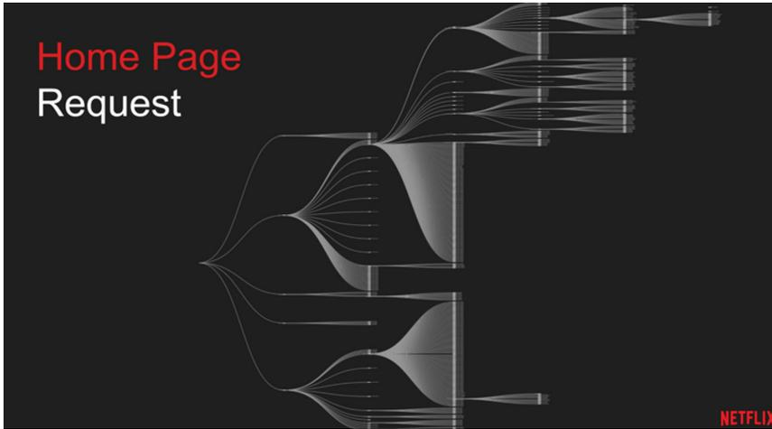
**Рис. 11.6** ❖ Диаграмма, показанная во время презентации Скотта Мэнсфилда из компании Netflix, демонстрирует, что запрос к домашней странице Netflix приводит к серии нисходящих вызовов сервисов. Распределенная трассировка позволяет вам увидеть это сложное дерево вызовов
