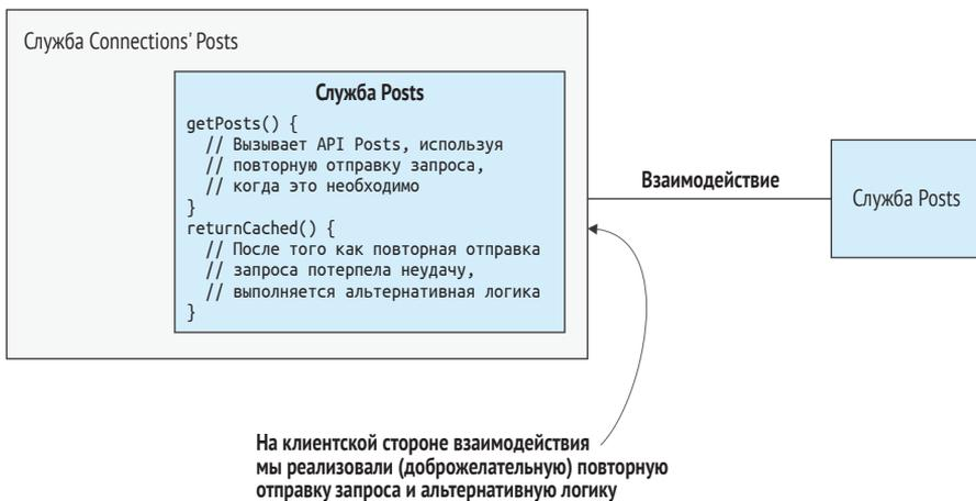
**Рис. 9.7** ❖ Реализация шаблонов на стороне клиента, таких как повторная отправка запроса и альтернативы, дает гораздо более надежную систему (мы перейдем к взаимодействию на стороне службы в следующей главе)
