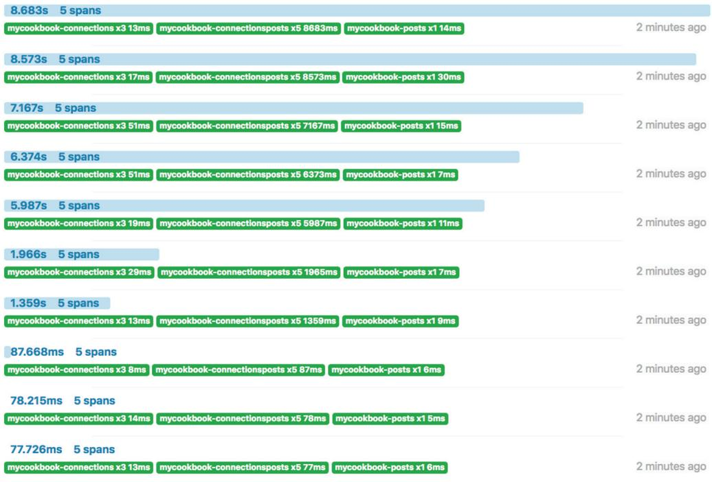
**Рис. 11.14** ❖ Когда работа сети восстанавливается, нисходящие запросы снова выполняются успешно, но, судя по времени, потраченному на выполнение запросов Connections' Posts, можно увидеть запас по интенсивности трафика и сколько потребовалось времени для его рассеивания
