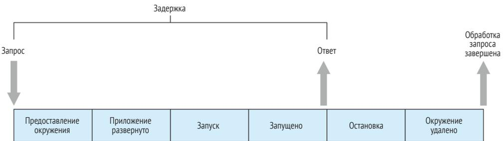
**Рис. 7.15** ❖ Для вызова одной функции пройдены все этапы жизненного цикла
