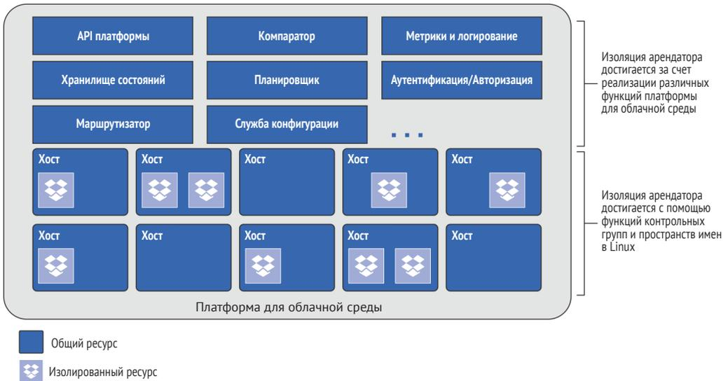
**Рис. 3.23** ❖ Истинная мультиарендность на уровне вычислений совместно использует ресурсы в плоскости управления, а также в слое вычислений (хост и ядро Linux), применяя контейнеры для достижения изоляции ресурсов
