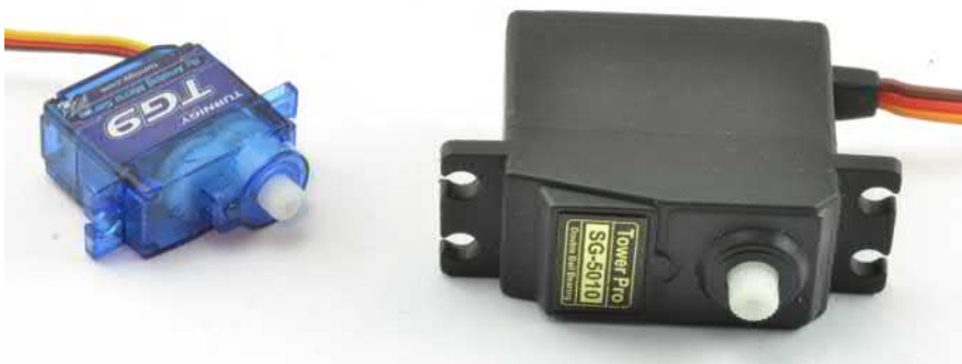
Рис. 9.1. Сервопривод 9g (слева) и стандартный серводвигатель (справа)
