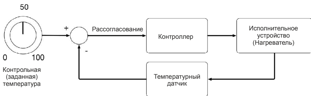
Рис. 12.1. Контур управления (на примере термостата)
