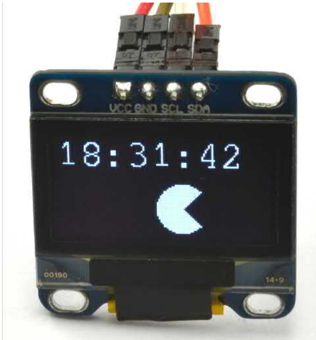
Рис. 14.7. Дисплей на основе технологии OLED
