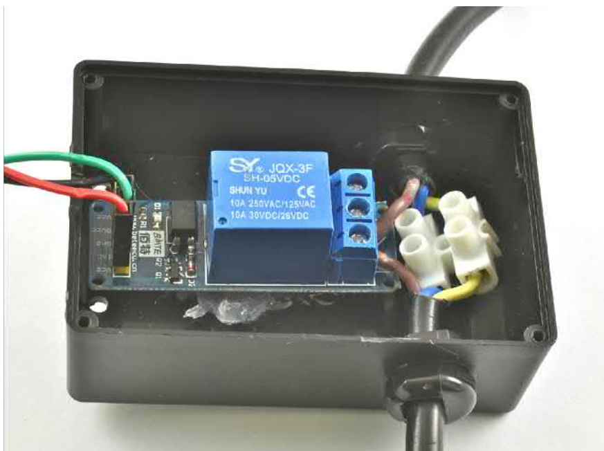
Рис. 13.6. Релейный модуль в пластмассовом корпусе
