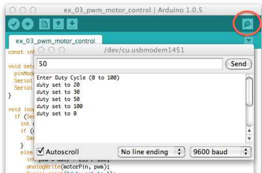
Рис. 7.5. Использование монитора последовательного интерфейса для управления скоростью электродвигателя
