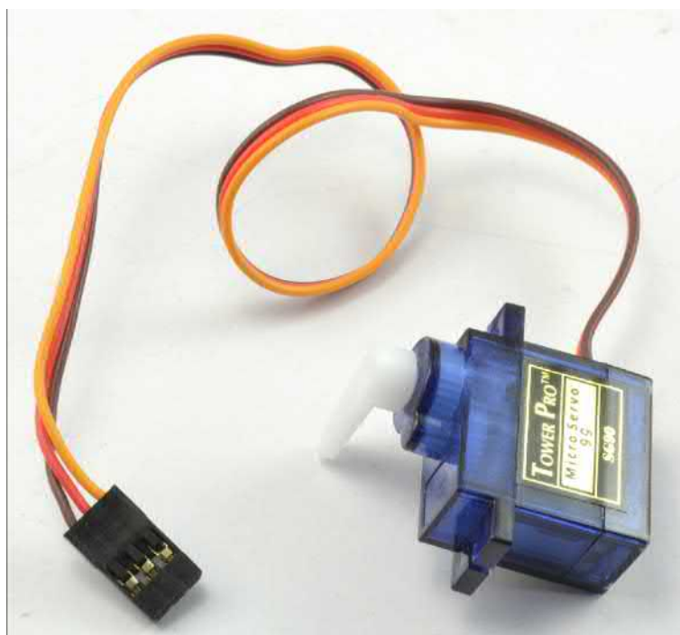
Рис. 9.6. Серводвигатель и его разъем
