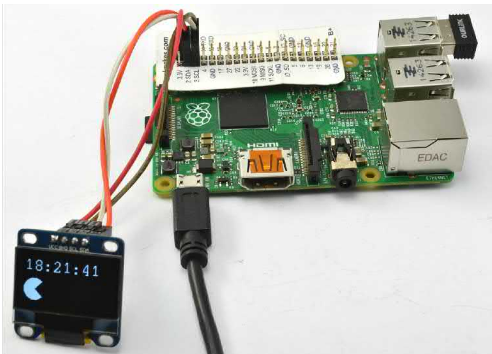
Рис. 14.8. Схема использования OLED-дисплея с Raspberry Pi в сборе
