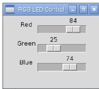
Рис. 6.13. Перемещаем ползунки для изменения цвета RGB-светодиода
