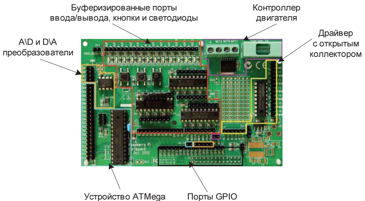
Рис. 6.23. Функциональные блоки платы Gertboard
