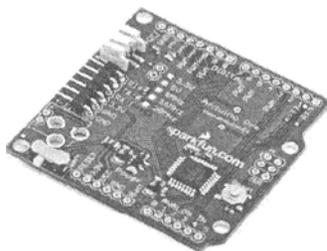
**Рис. 3.6.** Плата Arduino Pro
