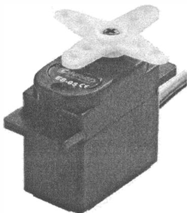
Рис. 16.1. Стандартный сервопривод компании Conrad Electronic SE
