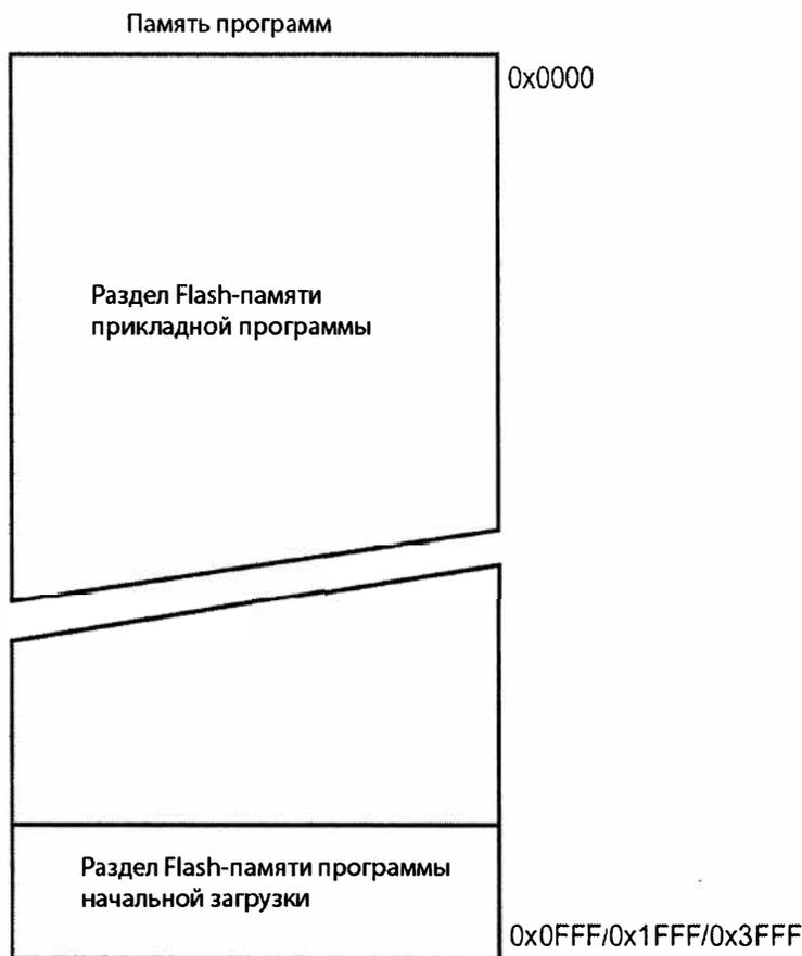
**Рис. 1.3.** Flash-память микроконтроллера ATmega168PA
