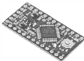
**Рис. 3.5.** Плата Arduino Pro Mini
