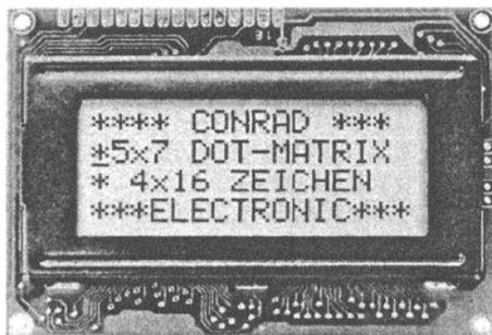
Рис. 17.1. Жидкокристаллический дисплей (источник: компания Conrad Electronic)
