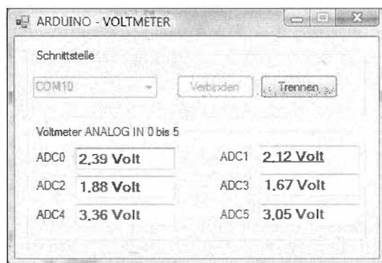
Рис. 10.24. 6-канальный вольтметр с VB.NET
