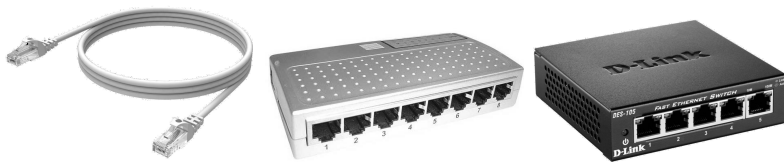
Рис. 6.2. Витая пара: кабель, концентратор, коммутатор
