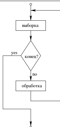
Рис. 4.4. Блок-схема цикла с побочным эффектом в условии
