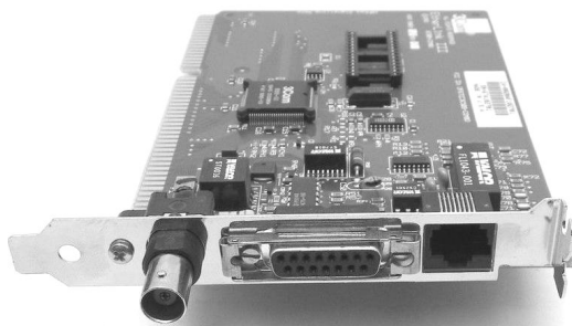
Рис. 6.3. Сетевая карта 3c509 (ЗСОМ) с разъёмами для подключения коаксиального кабеля (слева), внешнего адаптера (в центре) и кабеля витой пары (справа).
