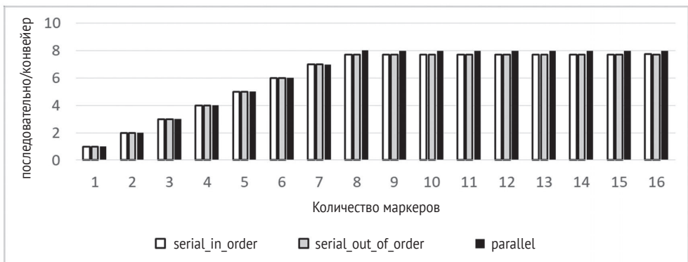
Рис. 16.21 ❖ Ускорение, достигаемое в различных режимах выполнения, когда конвейер с 8 фильтрами сбалансирован, на вход подается 8000 элементов, а количество маркеров постепенно увеличивается. Время работы каждого фильтра равно 100 мкс
