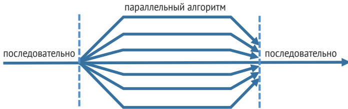
Рис. 2.1 ❖ Разветвление – соединение, характерное для параллельных алгоритмов TBB
