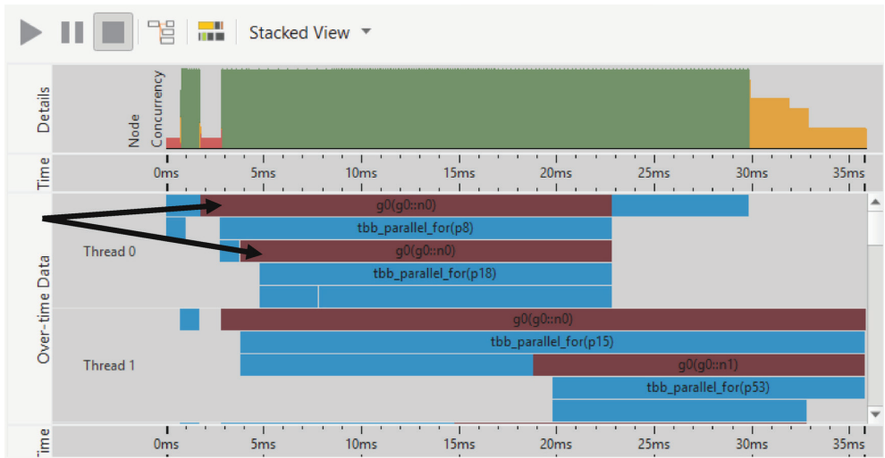
Рис. 17.39 ❖ Хронологии FGA, сгруппированные по узлу и региону. Мы видим, что поток 0 шабашничает, потому что конкурентно выполняет более одного параллельного региона
