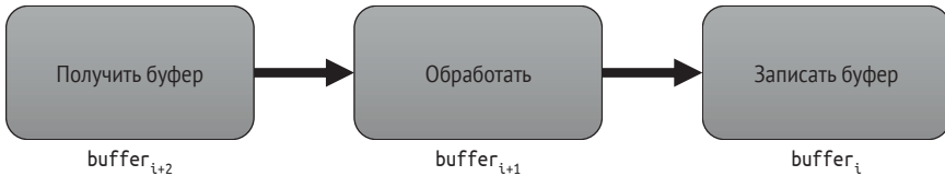
(a) Параллельный фильтр может параллельно обрабатывать более одного элемента
