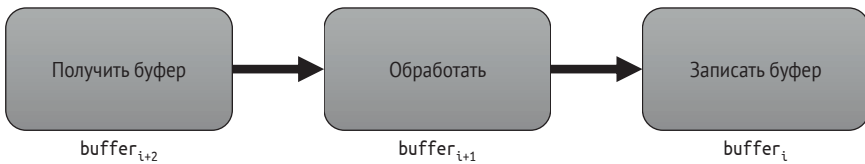
(а) Три буфера параллельно обрабатываются разными фильтрами
