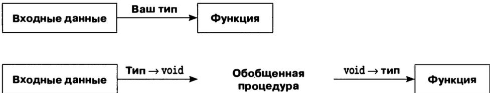
Рис. 10.1. Сравнение вызова функции напрямую и вызова из обобщенной процедуры
