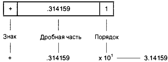
Рис. 3.3. Хранение числа \pi в формате числа с плавающей запятой (десятичная версия)
