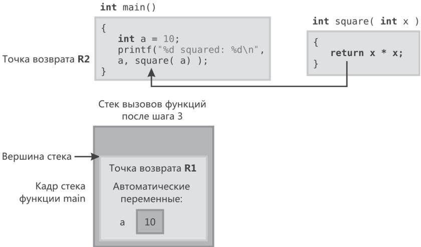
**Рис. 5.4** | Стек вызовов функций после того, как `square` вернет управление функции `main`
