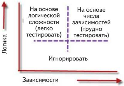
Рис. 10.2. Классификация компонентов на простые, трудные и несущественные, исходя из логической сложности и числа зависимостей
