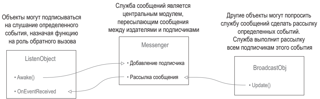
Рис. 7.17. Схема широковещательной рассылки сообщений
