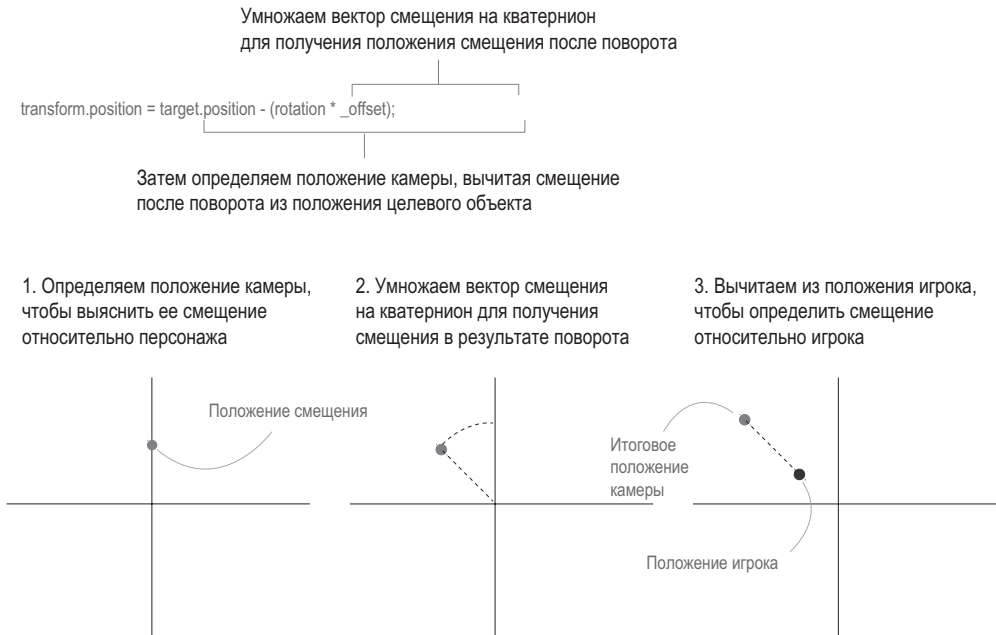
Рис. 8.7. Этапы вычисления положения камеры
