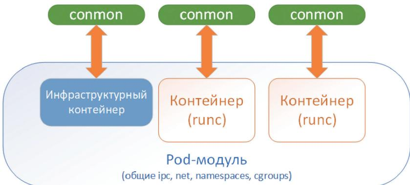
Рис. 4.1 Pod-модуль в архитектуре podman
