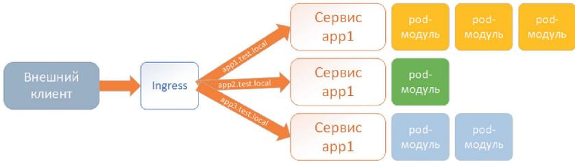
Рис. 6.4 ❖ Логическая схема работы Ingress Controller
