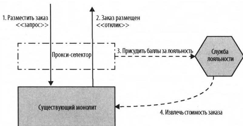
Рис. 3.33. Наша служба "Лояльности" должна загрузить дополнительные детали заказа для выяснения того, сколько баллов присуждать
