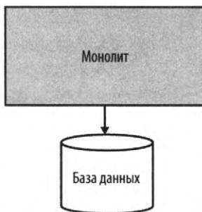
Рис. 1.6. Однопроцессный монолит: весь код упакован в один единственный процесс
