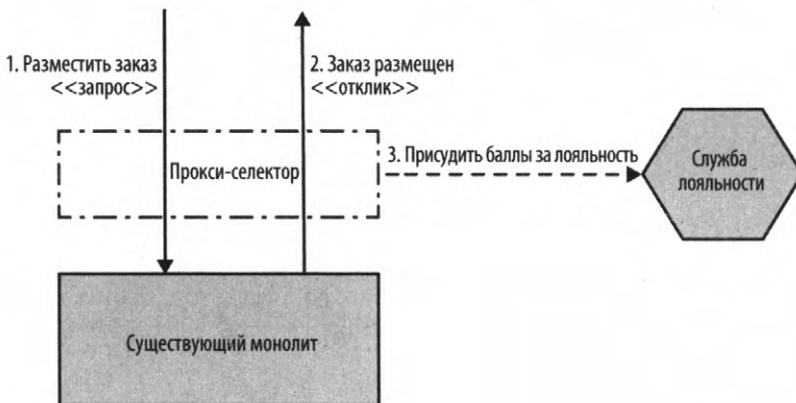
Рис. 3.32. Когда заказ успешно размещен, наш прокси-селектор обращается к службе "Лояльности" для начисления баллов клиенту
