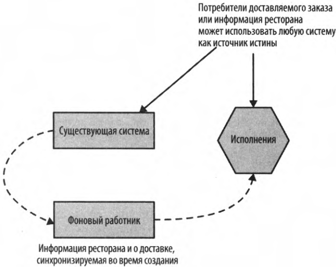
Рис. 4.21. Новая служба "Исполнения" использовалась для репликации данных, связанных с исполнением заказов, из существующей системы
