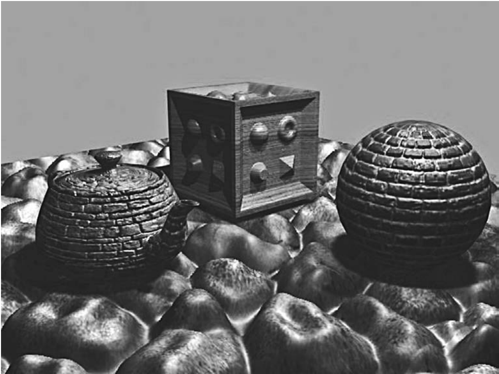
Рис. 11.54. Пример реализации смещающего наложения в DirectX 9. Простая исходная геометрия тесселируется в динамическом режиме для получения элементов поверхности
