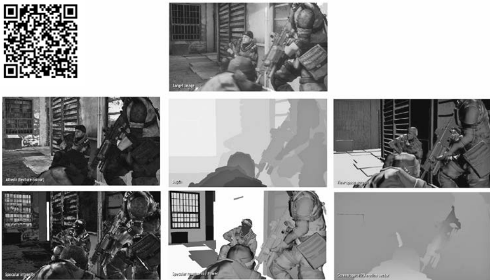
Рис. 11.62. Снимки экрана из игры Killzone 2 студии Guerrilla Games, демонстрирующие некоторые типичные компоненты G-буфера, используемые при отложенном рендеринге. Сверху представлен окончательный результат рендеринга. Ниже по часовой стрелке от верхнего левого угла: альbedo (диффузный цвет), глубина, нормаль в пространстве обзора, двухмерный вектор движения в экранном пространстве (для размытия движения), степень и интенсивность зеркального отражения
