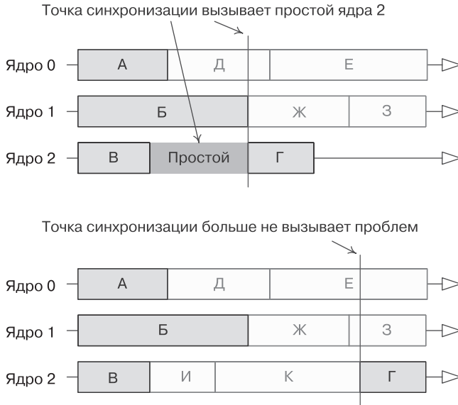
Рис. 16.19. Задание Г зависит от заданий А, Б и В. Вверху: если попытаться выполнить Г на ядре 2 сразу после В, ядро будет бездействовать, пока не завершится Б. Внизу: если отсрочить начало работы Г до тех пор, пока не завершатся А, Б и В, ядро 2 можно освободить для выполнения других заданий и тем самым устранить время простоя, вызванное точкой синхронизации
