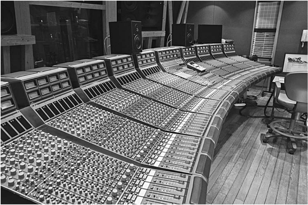
Рис. 14.38. Многоканальный микшерный пульт от Focusrite с 72 входами и 48 выходами
