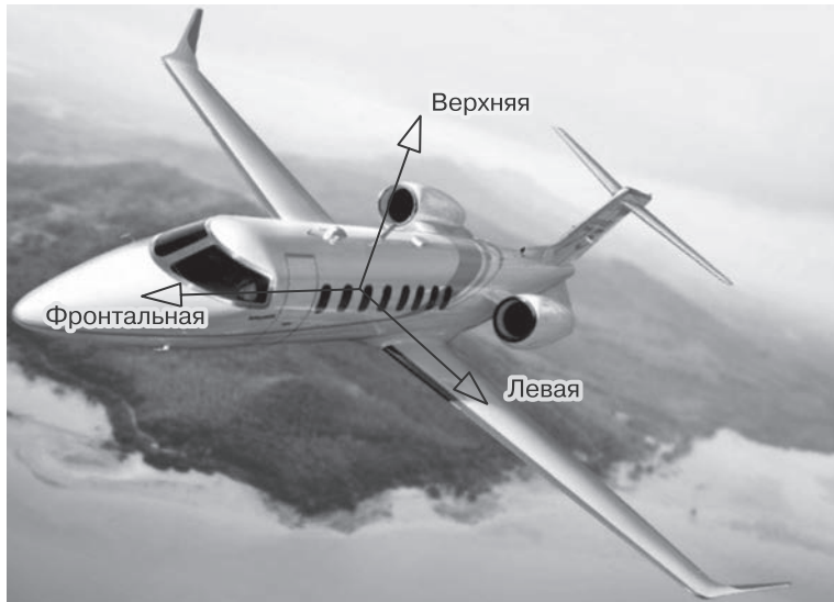
Рис. 5.18. Один из возможных вариантов базисных векторов фронтальной, левой и верхней осей для пространства модели самолета
