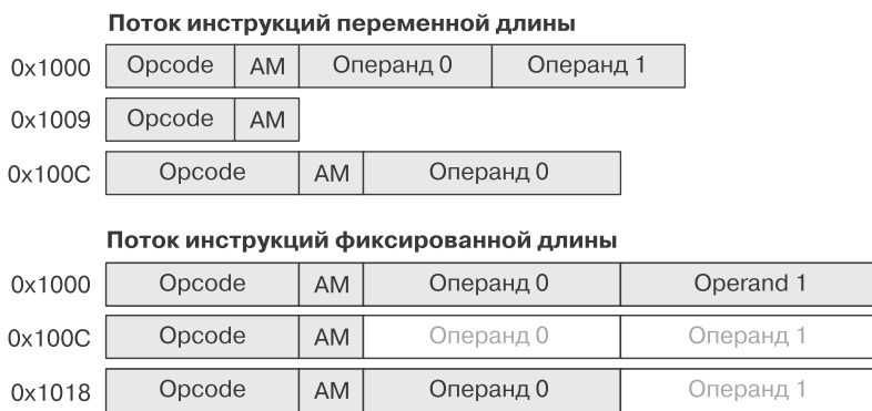
Рис. 3.21. Две гипотетические схемы кодирования команд машинного языка. Вверху: в схеме кодирования с переменной шириной разные инструкции могут занимать разное количество байтов в памяти. Внизу: при кодировании инструкций с фиксированной шириной для каждой из них в потоке команд используется одинаковое количество байтов
