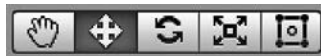
Рис. 2.5. Переключатель режимов в представлении сцены, в данном случае включен режим Translate (Перемещение)
