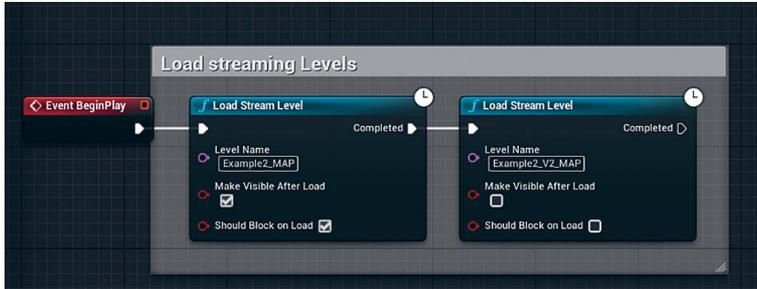
**Рисунок 18.8** Узлы Load Stream Level, соединенные с узлом BeginPlay Event
