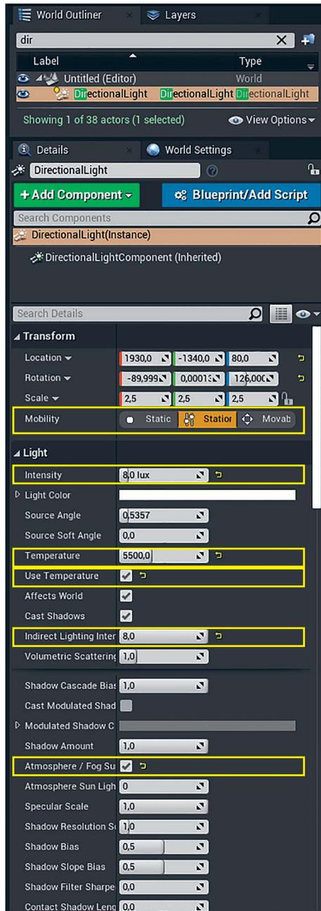
Рисунок 14.3 Свойства Directional Light в Details Panel
