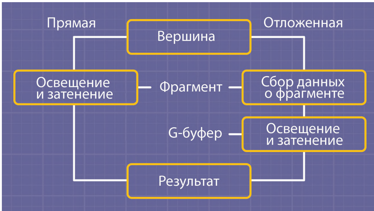
Рис. 10.10. Прямой рендер и отложенное затенение. Прямой подход вычисляет весь свет в шейдере фрагментов, в то время как отложенный подход помещает описания каждого фрагмента в буферы, которые могут быть использованы для освещения сцены в другое время.
