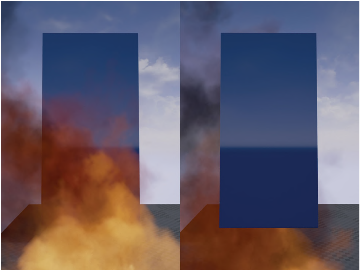
Рис. 10.17. Два отдельных полупрозрачных объекта, перекрывающих друг друга: слева Separate Translucency включено, а справа нет
