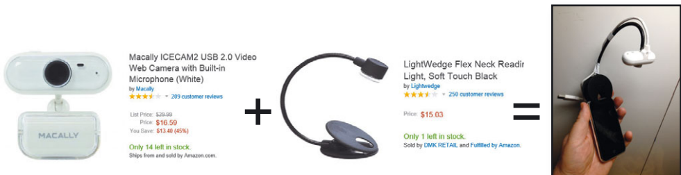
Легкая веб-камера + легкий зажим с гибким держателем = устройство Brundlefly
