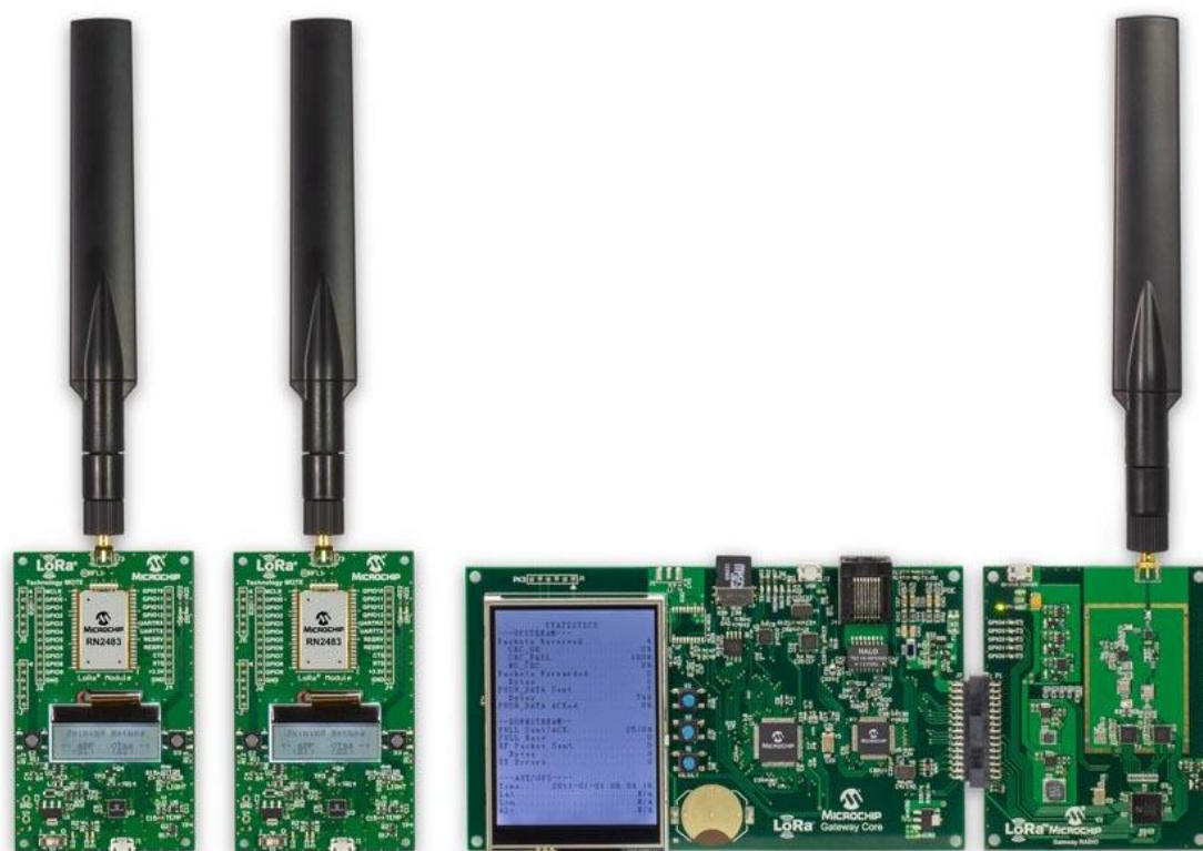
Рис. 25 – Базовый комплект LoRa модулей
