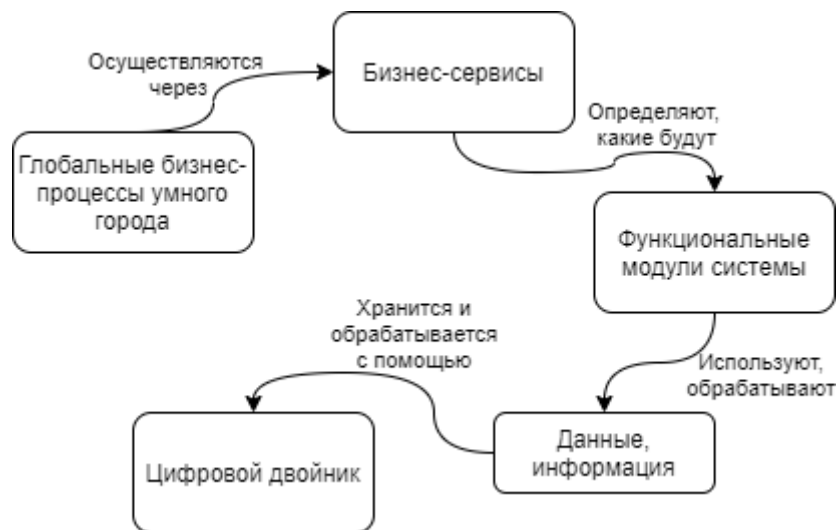
Рисунок 2.6 – Логика применения архитектурного метода для проектирования цифрового двойника
