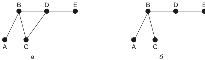
Рис. 4.6. На левом графе существует цикл между вершинами B, C и D, поэтому он не является деревом. На правом графе ребро, соединяющее C и D, удалено, так что этот граф — дерево
