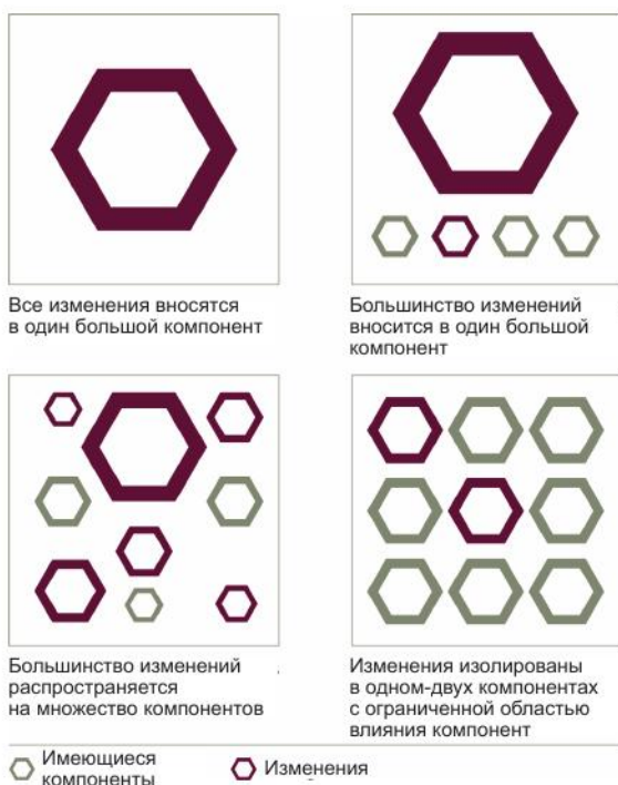
Рис. 8.1 ❖ Деление системы на компоненты: с худшим балансом вверху слева и с лучшим – внизу справа
