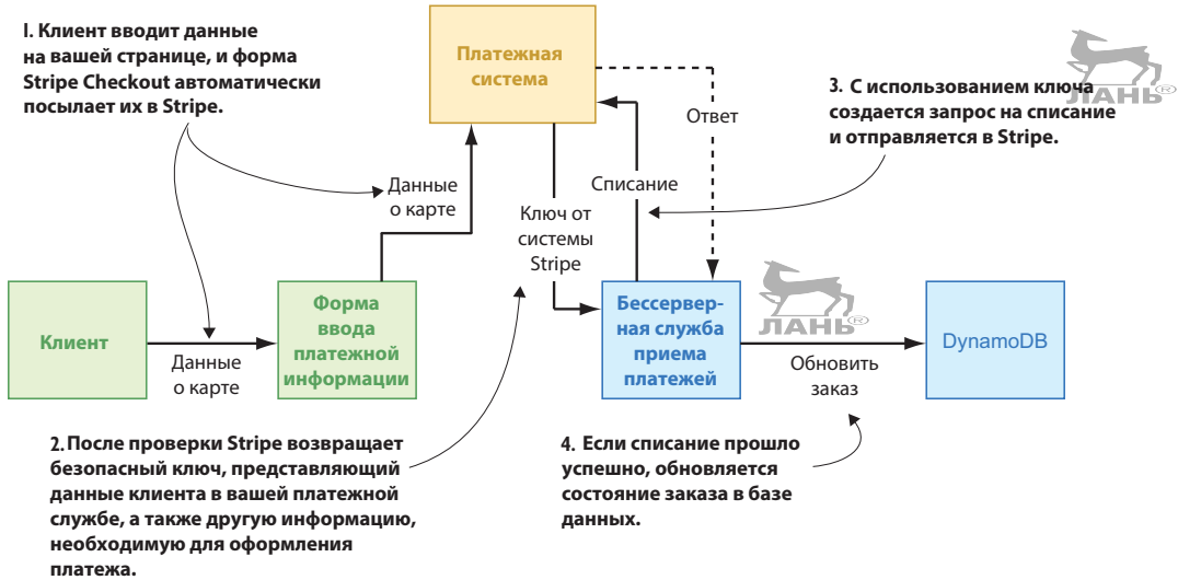
Рис. 12.6. Диаграмма, иллюстрирующая процесс оплаты с использованием платежной системы Stripe
