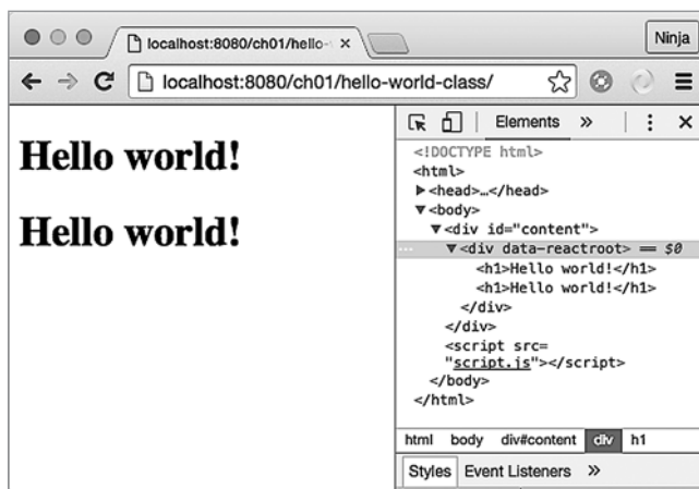
Рис. 2.6. Рендер элемента, созданного на базе нестандартного класса компонента HelloWorld
