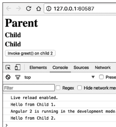
Рис. 6.16. Получение доступа к API потомка
