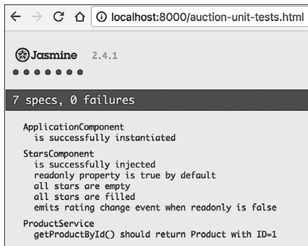
Рис. 9.7. Тестирование онлайн-аукциона с использованием средства запуска тестов на основе HTML
