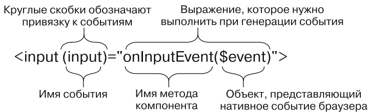
Рис. 5.1. Синтаксис привязки событий
