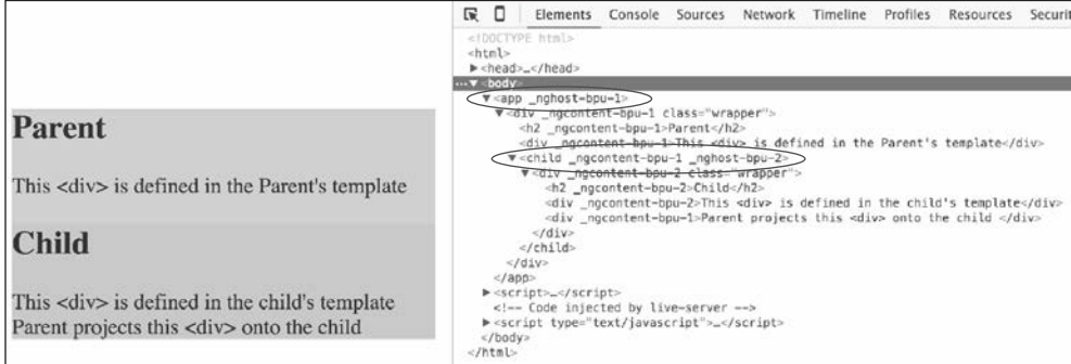
Рис. 6.7. Запуск файла basic-ng-content.ts в режиме ViewEncapsulation.Emulated
