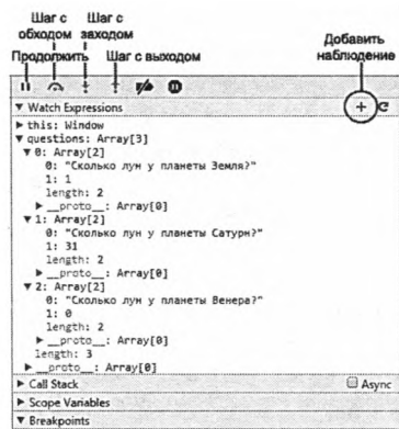
Рис. 17.7. Окно Watch (Наблюдение) отображает значения разных переменных в ходе выполнения программы. Вы можете добавлять в список собственные инструкции, появляющиеся на фоне серых полос в верхней части окна
