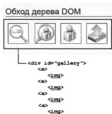
Рис. 15.3. При создании выборки (например, чтобы добавить для элемента обработчик события, как для изображенных на рисунке элементов a ) программист часто планирует работать не с выбранными элементами, а с другими, которые как-то связаны с выбранными (скажем, добавить описание к элементу div или изменить элемент img ). В таких случаях на помощь приходят функции обхода дерева DOM из библиотеки jQuery
