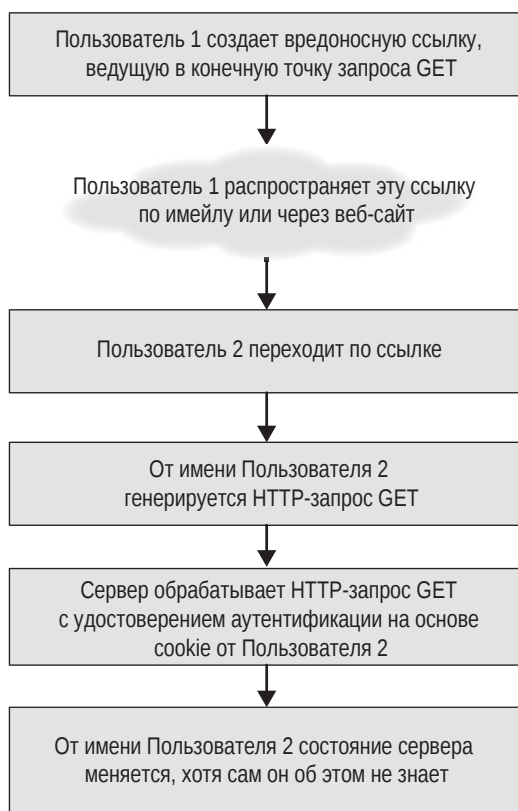
Рис. 11.1. CSRF — это распространение вредоносной ссылки, щелчок по которой приводит к выполнению HTTP-запроса GET от имени аутентифицированного пользователя.
