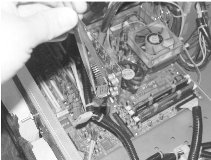
*Рис. 2.8. Устанавливаем поврежденный чип BIOS (фотография автора)*
