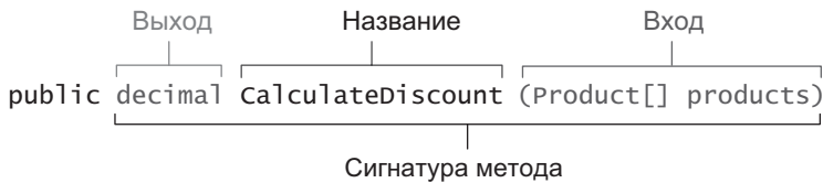
Рис. 6.5. Метод CalculateDiscount() имеет одно входное значение (массив продуктов) и одно выходное значение (скидка). И входное, и выходное значение явно выражены в сигнатуре метода, что делает CalculateDiscount() математической функцией
