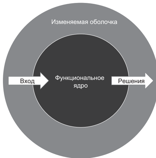
Рис. 6.9. В функциональной архитектуре функциональное ядро реализуется с использованием математических функций и принимает все решения в приложении. Изменяемая оболочка предоставляет функциональному ядру входные данные и интерпретирует его решения, применяя побочные эффекты к внепроцессным зависимостям (например, базе данных)
