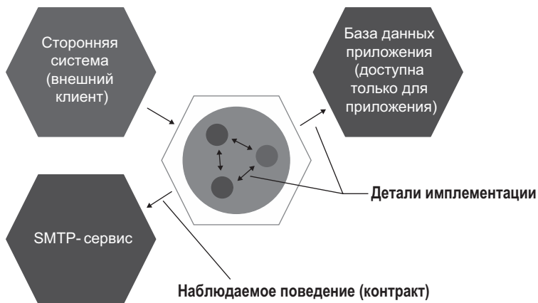
Рис. 5.14. Взаимодействия с внепроцессной зависимостью, которую нельзя увидеть извне, являются деталями имплементации. Они не обязаны оставаться без изменений после рефакторинга, а следовательно, не должны проверяться с использованием моков
