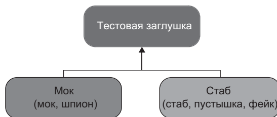
Рис. 5.1. Все разновидности тестовых заглушек можно разделить на два типа: моки и стабы
