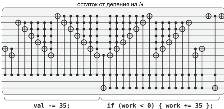
Рис. 12.19. Квантовые операции для умножения на 2 с вычислением остатка от деления на 35
