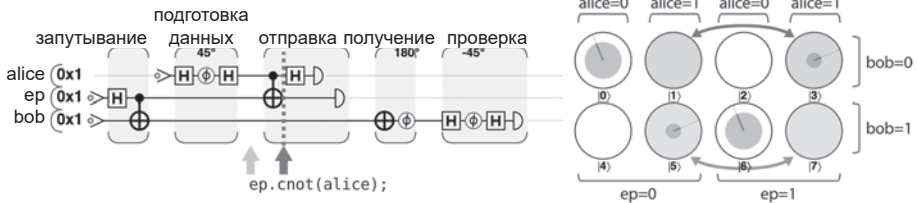
Рис. 4.9. Шаг 3.1: связывание данных с запутанной парой
