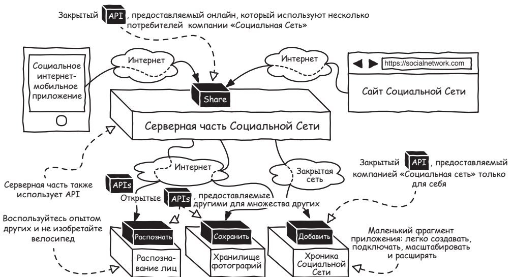
Рис. 1.4. Система, состоящая из открытых и закрытых программных деталей LEGO®, подключенных через API
